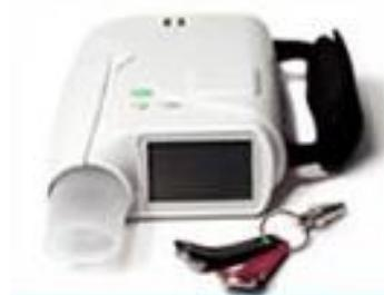
Slika 48. Sustav AERx® za primjenu opioidnih analgetika. Sustav je zaštićen s ključem i zaslonom s podacima o dozi i vremenu doziranja. Samo uz upotrebu ključa sustav se pokreće, te se na taj način omogućuje sigurnost primjene. Identifikacija pacijenta sprječava moguću zloporabu (96).
