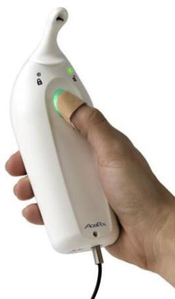
Slika 57. Sustav ZALVISO™ s djelomičnom kontrolom od strane pacijenta s radio-detekcijskim naprstkom koji omogućuje točnu identifikaciju pacijenta i time omogućuje personalizirano doziranje i primjenu (6)
