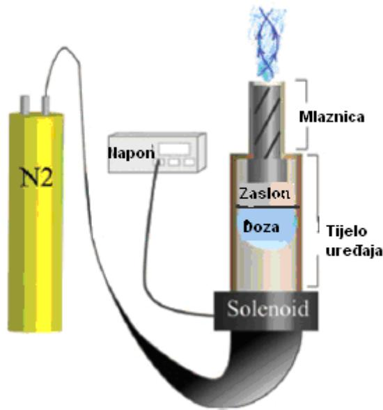
Slika 34. Shematski prikaz uređaja za usmjerenu dostavu lijeka u olfaktorno područje nosne šupljine. Dušik pod tlakom se kontrolira pomoću solenoida, koji omogućuje ispuštanje plina u intervalima od 0,1 sekunde. Plin ulazi u mlaznicu i miješa se s dozom lijeka u tekućem obliku te nastaje aerosol. U mlaznici se formira vorteks (kružno gibanje plina) koji prenosi aerosol u određenom smjeru prema olfaktornom području (78).
