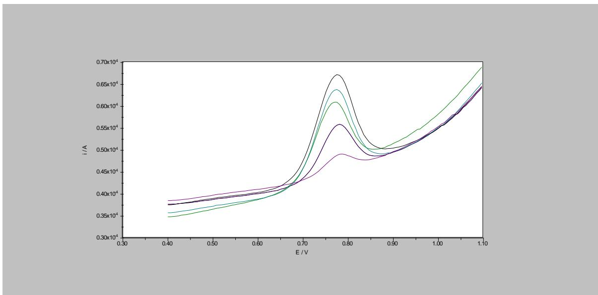
Slika 19. Pravokutnovalni voltamogrami drugog dijela koncentracijskog niza otopina nepafenaka u BR puferu pH 6 snimljeni pri optimalnim uvjetima. Prikazane koncentracije:  $2 \times 10^{-6} \text{ M}$  (ljubičasto),  $6 \times 10^{-6} \text{ M}$  (plavo),  $1 \times 10^{-5} \text{ M}$  (maslinasto zeleno),  $1,5 \times 10^{-5} \text{ M}$  (tirkizno) i  $2 \times 10^{-5} \text{ M}$  (crno)
