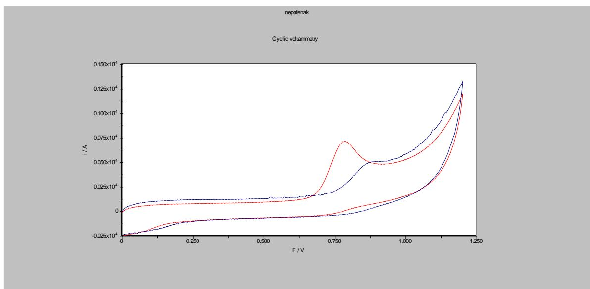
Slika 7. Ciklički voltamogrami nepafenaka koncentracije  $1 \times 10^{-4}$  M u BR puferu pH 6 snimljen pri brzini promjene potencijala 100 mV/s pri čemu je GCE modificirana s grafenom u 0,3 %-tnoj etanolnoj otopini nafiona (crveno) i grafenom u suspenziji kitozana u 1 %-tnoj octenoj kiselini (plavo)
