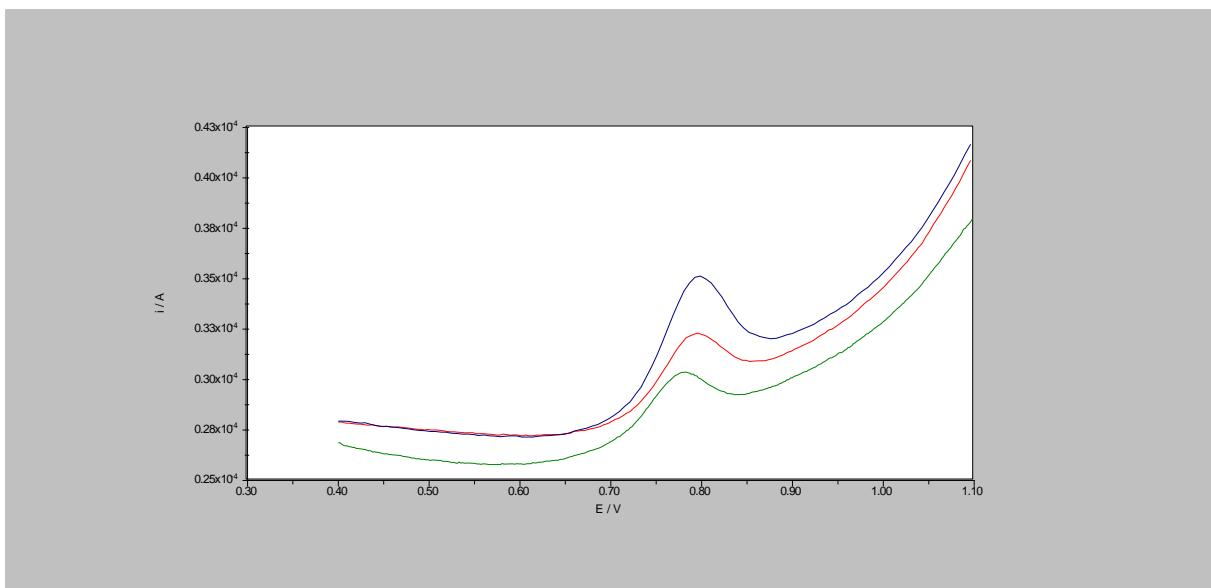
Slika 13. Pravokutnovalni voltamogrami nepafenaka koncentracije  $1 \times 10^{-5}$  M u BR puferu pH 6 snimljeni pri različitim porastima potencijala: 2 mV (zeleno), 4 mV (crveno) i 6 mV (plavo). Ostali uvjeti mjerena: GCE površine modificirane s grafen nanopločicama i ugljikvim nanovlaknima (oboje 1 mg/mL) u 0,3 %-tnoj etanolnoj otopini nafiona; uz frekvenciju 50 Hz te amplitudu pulsa 25 mV
