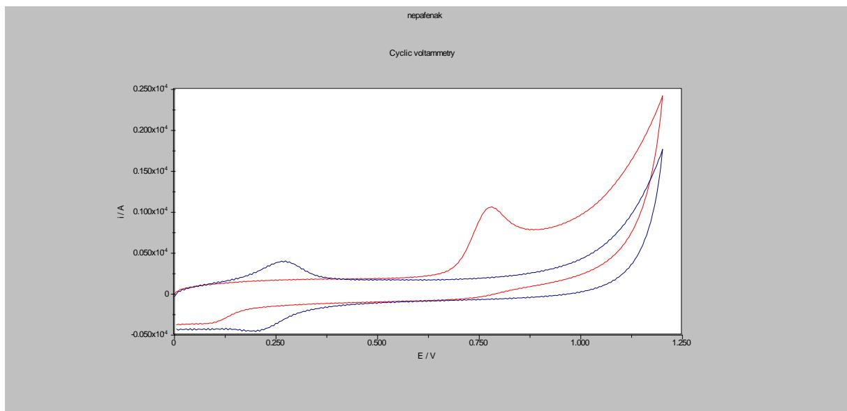
Slika 8. Usporedba cikličkih voltamograma  $1 \times 10^{-4}$  M nepafenaka u BR puferu pH 6 (crveno) i samog BR pufera pH 6 (plavo), snimljenih GCE površine modificirane s grafen nanopločicama i ugljikovim nanovlaknima u 0,3 %-tnoj otopini nafiona u etanolu.
