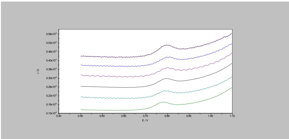
Slika 11. Pravokutnovalni voltamogrami nepafenaka koncentracije  $1 \times 10^{-5}$  M u BR puferu pH 6 snimljeni pri različitim frekvencijama: 30 Hz (zeleno), 40 Hz (tirkizno), 50 Hz (crno), 60 Hz (ljubičasto), 70 Hz (modro) i 80 Hz (tamno plavo). Ostali uvjeti mjerena: GCE površine modificirane s grafen nanopločicama i ugljikvim nanovlaknima (oboje 1 mg/mL) u 0,3 %-tnoj etanolnoj otopini nafiona; amplituda pulsa 25 mV te porast potencijala od 4 mV
