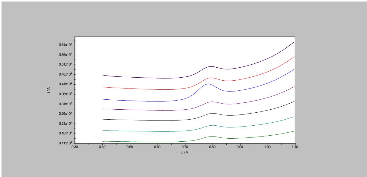
Slika 12. Pravokutnovalni voltamogrami nepafenaka koncentracije  $1 \times 10^{-5}$  M u BR puferu pH 6 snimljeni pri različitim amplitudama pulsa: 10 mV (zeleno), 15 mV (tirkizno), 20 mV (crno), 25 mV (ljubičasto), 30 mV (plavo), 35 mV (crveno) i 40 mV (tamno plavo). Ostali uvjeti mjerena: GCE površine modificirane s grafen nanopločicama i ugljikvim nanovlaknima (oboje 1 mg/mL) u 0,3 %-tnoj etanolnoj otopini nafiona; uz frekvenciju 50 Hz te porast potencijala od 4 mV
