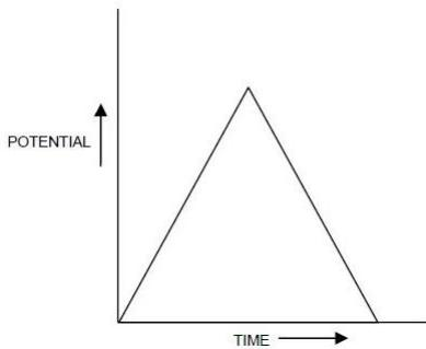
Slika 3. Prikaz promjene potencijala kod CV tijekom vremena. (Preuzeto s [www.azom.com](http://www.azom.com))
