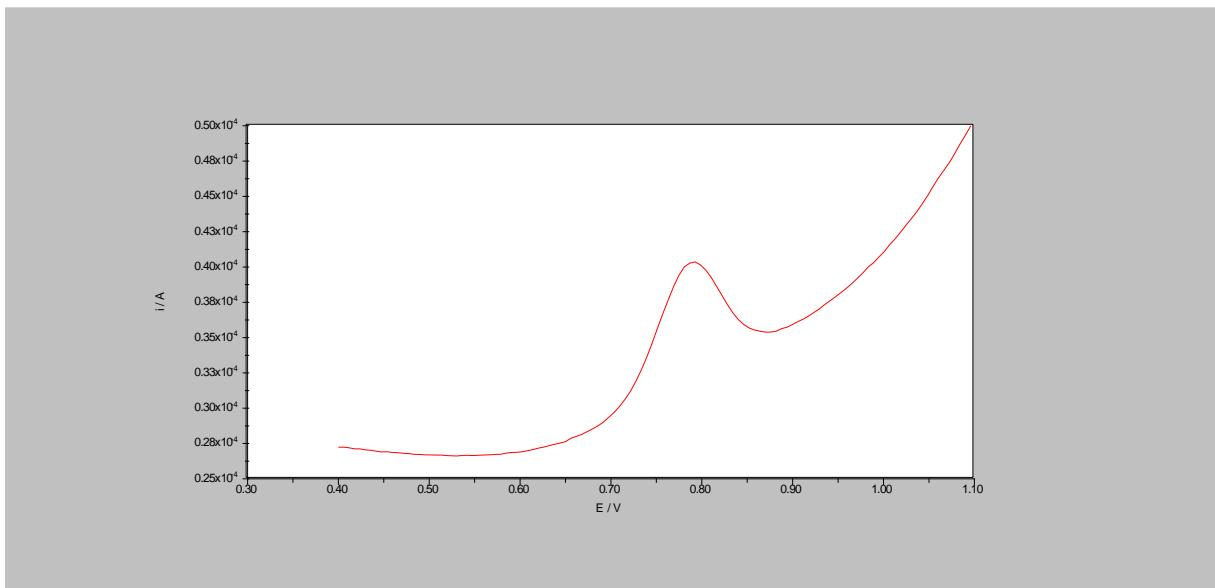
Slika 14. Optimalni uvjeti SWV za određivanje nepafenaka. Snimljen je nepafenak koncentracije  $1 \times 10^{-5} M$  u BR puferu pH 6 na GCE površine modificirane s grafen nanopločicama i ugljikovim nanovlaknima (oboje koncentracije 1 mg/mL) u 0,3 %-tnoj etanolnoj otopini nafiona uz parametre mjerena: frekvencija 50 Hz, amplituda pulsa 30 mV i porast potencijala od 6 mV
