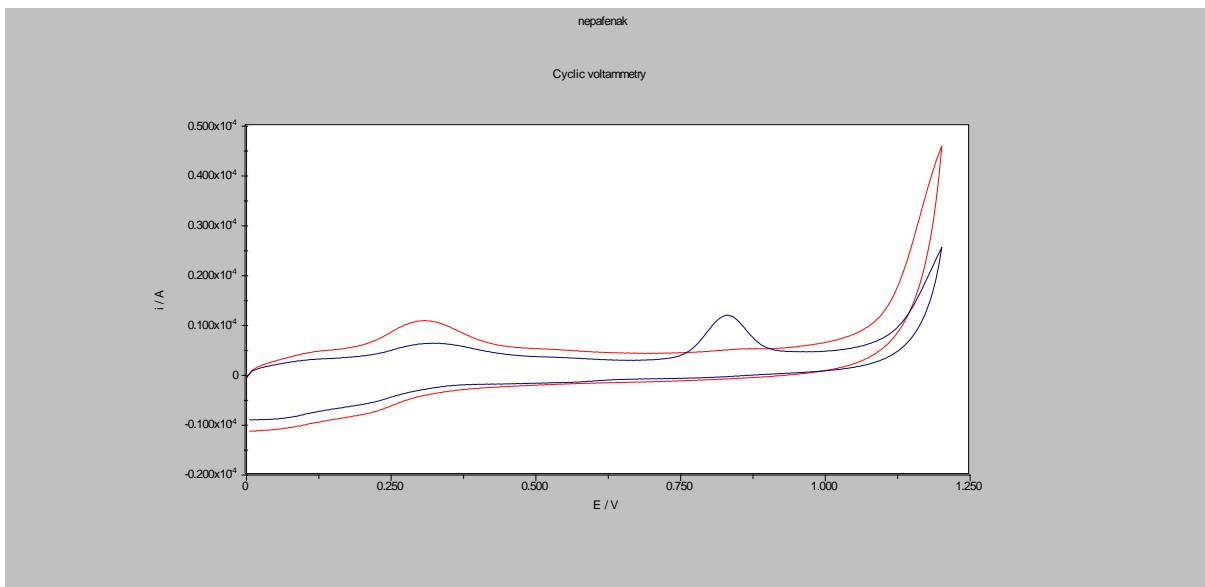
Slika 10. Razgradnja nepafenaka u kiselom pH. CV, nepafenak koncentracije  $1 \times 10^{-4}$  M u BR puferu pH 2 odmah po pripravi radne otopine (plavo) i nakon stajanja (crveno). Uvjeti mjerena: brzina promjene potencijala 100 mV/s, GCE površine modificirane s ugljikovim nanovlaknima i grafen nanopločicama (oboje po 1 mg/mL) u 0,3 %-tnoj otopini nafiona u etanolu
