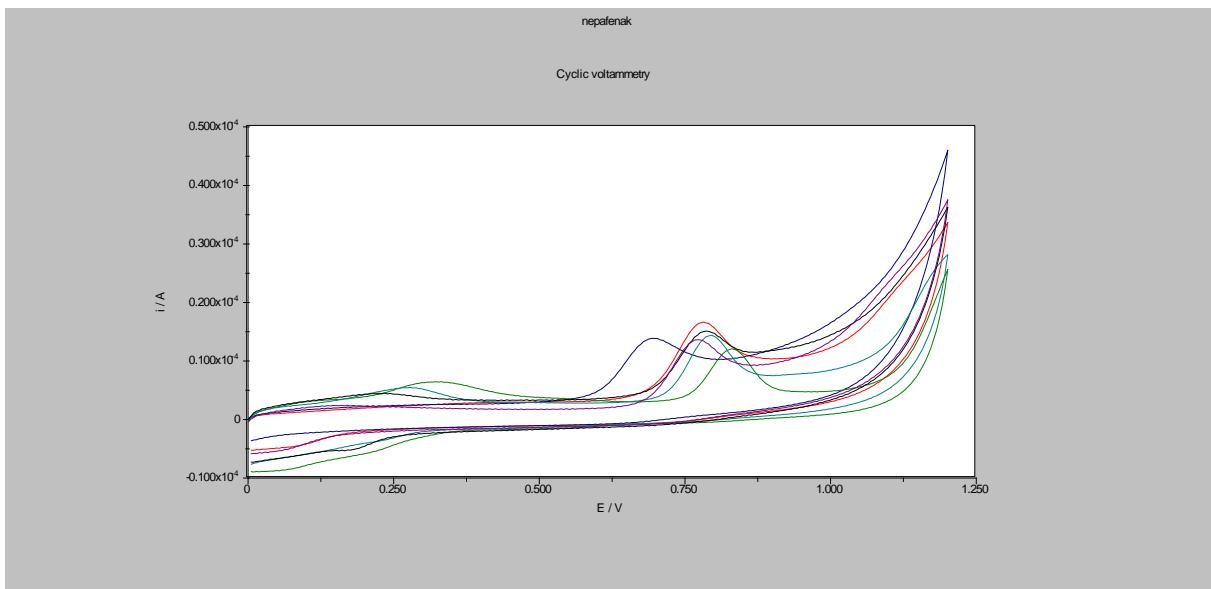
Slika 9. Ciklički voltamogrami nepafenaka koncentracije  $1 \times 10^{-4}$  M snimljeni pri brzini promjene potencijala 100 mV/s na GCE površine modificirane s grafen nanopločicama i ugljikovim nanovlaknima (oboje 1 mg/mL) u 0,3 %-tnoj etanolnoj otopini nafiona pri različitim pH vrijednostima radnih otopina: pH 2 (zeleno), pH 4 (tirkizno), pH 5 (crno), pH 6 (crveno), pH 7 (ljubičasto) i pH 8 (plavo)
