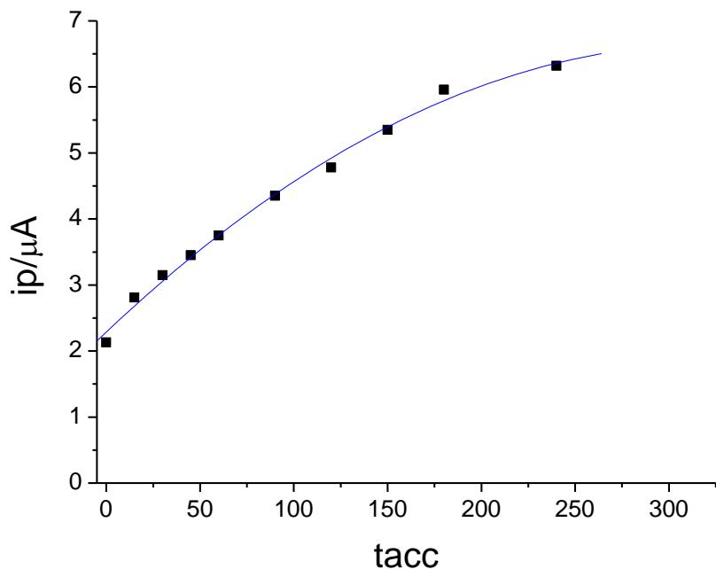
Slika 16. Grafički prikaz ovisnosti izmjerenog strujnog vrha nepafenaka koncentracije  $5 \times 10^{-6}$  M o vremenu akumulacije kod *stripping* SWV.
