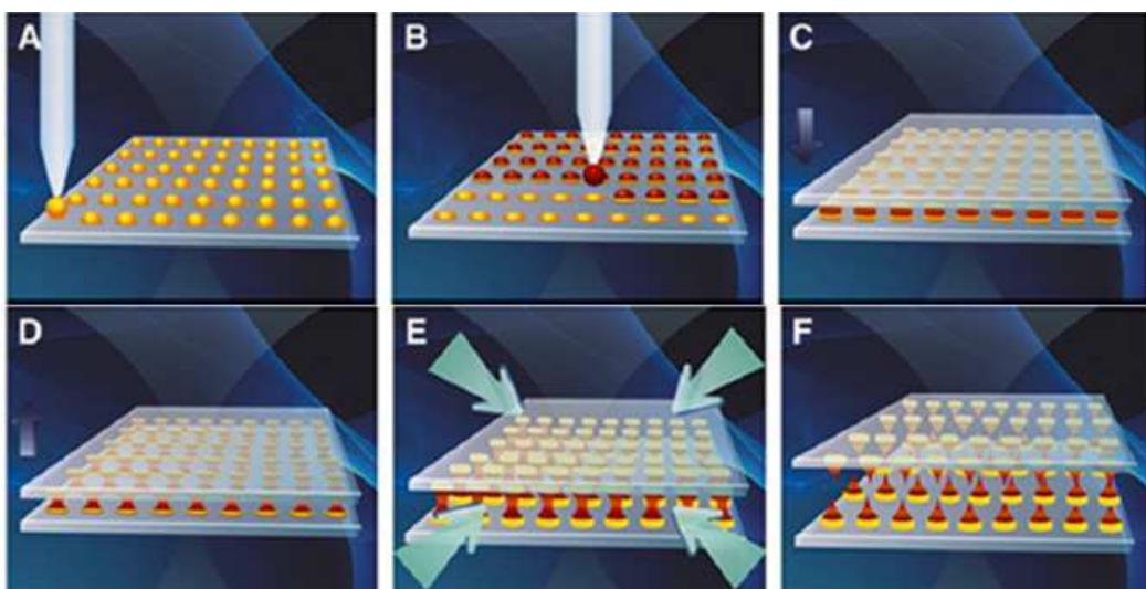
**Slika 10.** Shematski prikaz proizvodnje razgradljivih MN DAB metodom: A) Razdjeljivanje kapljica biopolimera na ravnu površinu za izradu osnovne strukture; B) Razdjeljivanje kapljica s djelatnom tvarina ravnu površinu za izradu osnovne strukture; C) Pomicanje gornje ploče prema donjoj sve dok se kapljice ne dodirnu; D) Kontrola duljine MN; E) Odvajanje dviju ploča stvarajući nizove razgradljivih MN na gornjoj i donjoj ploči (prilagođeno prema literurnom navodu 56).
