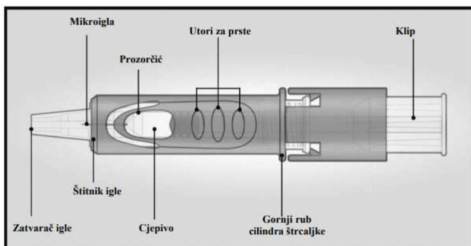
**Slika 13.** Intanza suspenzija za injekciju - Mikroinjekcijski sustav (prilagođeno prema literarnom navodu 89).
