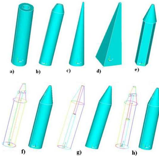
**Slika 6.** Shematski prikaz različitih oblika mikroigli: a) cilindrični; b) suženi/zašiljeni vrh; c) stožasti; d) kvadratni; e) peterokutna baza sa stožastim vrhom; f) pojedinačni lumen s bočnim otvorima; g) dvostruki lumen; h) dvostruki lumen s bočnim otvorima (prilagođeno prema literaturnom navodu 40).
