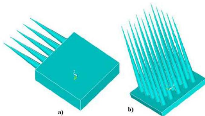
**Slika 7.** Shematski prikaz razvrstavanja mikroigli: a) *in-plane* dizajn; b) *out-of-plane* dizajn (prilagođeno prema literaturnom navodu 40).
