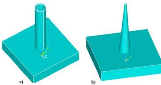
**Slika 8.** Shematski prikaz vrsta mikroigli: a) šuplja MN; b) čvrsta MN (prilagođeno prema literarnom navodu 40).
