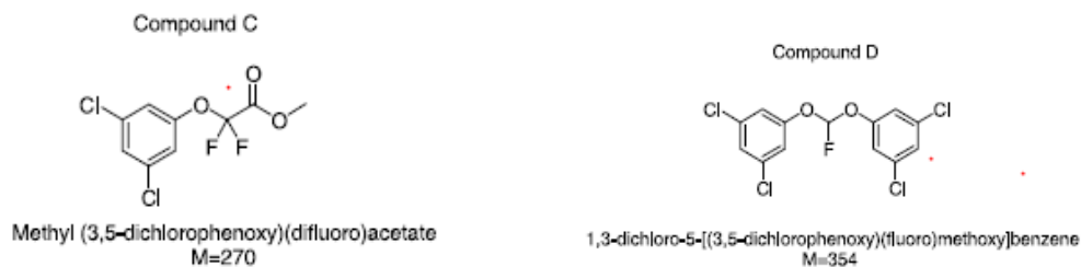
Slika 19. Struktura 2 od 4 različita nusprodukta dobivena pri sintezi 1,3-dikloro-5-(difluorometoksi)benzena; preuzeto iz [47].
