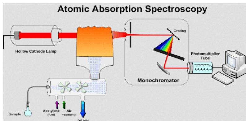
Slika 2. Atomsko apsorpcijski spektrofotometar
