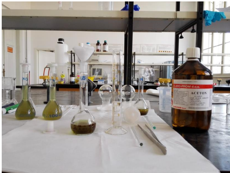
Slika 23. Priprema za reekstraciju ostataka droge na vati acetonom.
