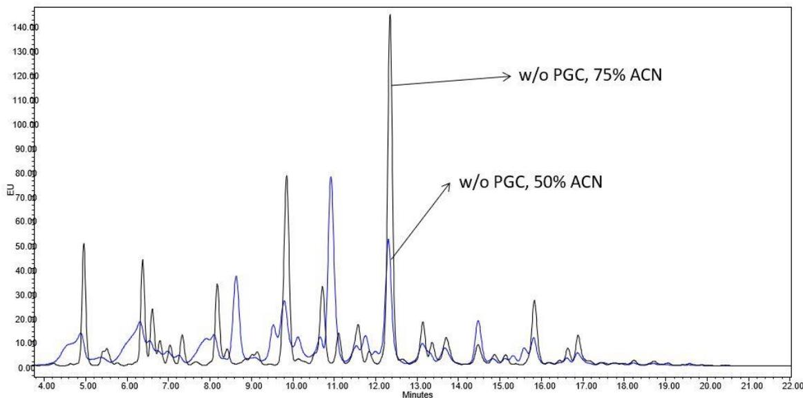
**Slika 12. Usporedba kromatograma dobivenih mjerenjem uzoraka N-glikana proteina plazme obilježenih 2-AB-om, priredeni bez korištenja PGC-a sa 75 % i 50 % ACN-a. Uzorci s 50 % ACN-a pokazuju jako širenje vršaka na početnom dijelu kromatograma.**
