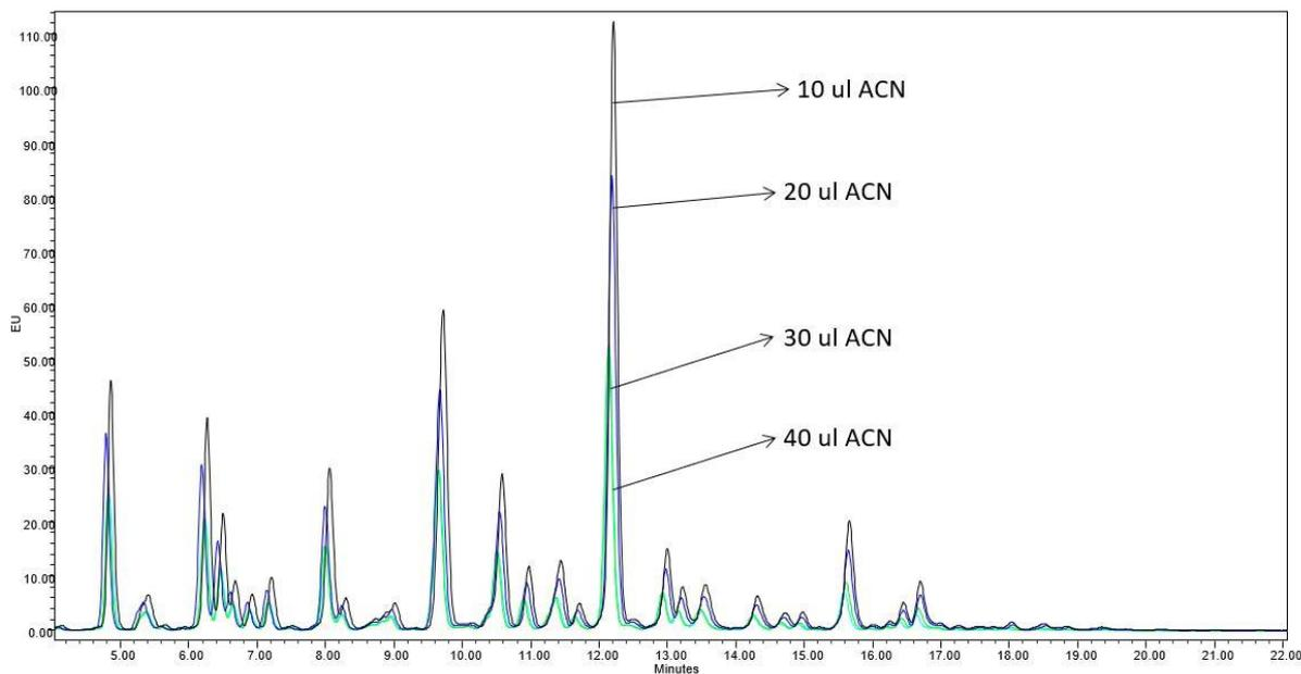
**Slika 14. Usporedba kromatograma dobivenih mjerenjem uzoraka N-glikana proteina plazme obilježenih 2-AB-om i prirednih ukoncentriranjem PGC-om te naknadnim dodavanjem 10  $\mu$ l ACN-a, 20  $\mu$ l ACN-a, 30  $\mu$ l ACN-a i 40  $\mu$ l ACN-a u eluat. Postignut je normalan kromatografski profil.**
