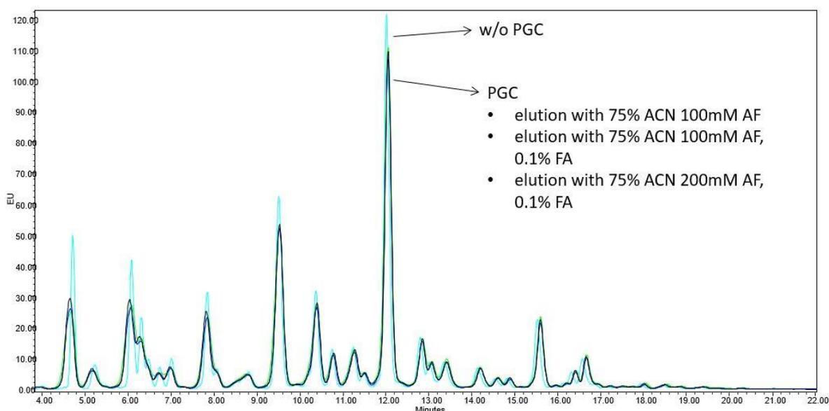
**Slika 11. Usporedba kromatograma dobivenih mjerenjem uzorka N-glikana proteina plazme obilježenog s 2-AB-om, prirednog bez korištenja PGC-a i uzorka N-glikana proteina plazme, obilježenih s 2-AB-om i ukoncentriranih PGC-om te u zadnjem koraku eluiranih sa 100 mM AF, 100 mM AF + FA ili s 200 mM AF + FA. Vršci pokazuju jednako retencijsko vrijeme. Na početnom dijelu kromatograma vidljivo je širenje vršaka.**
