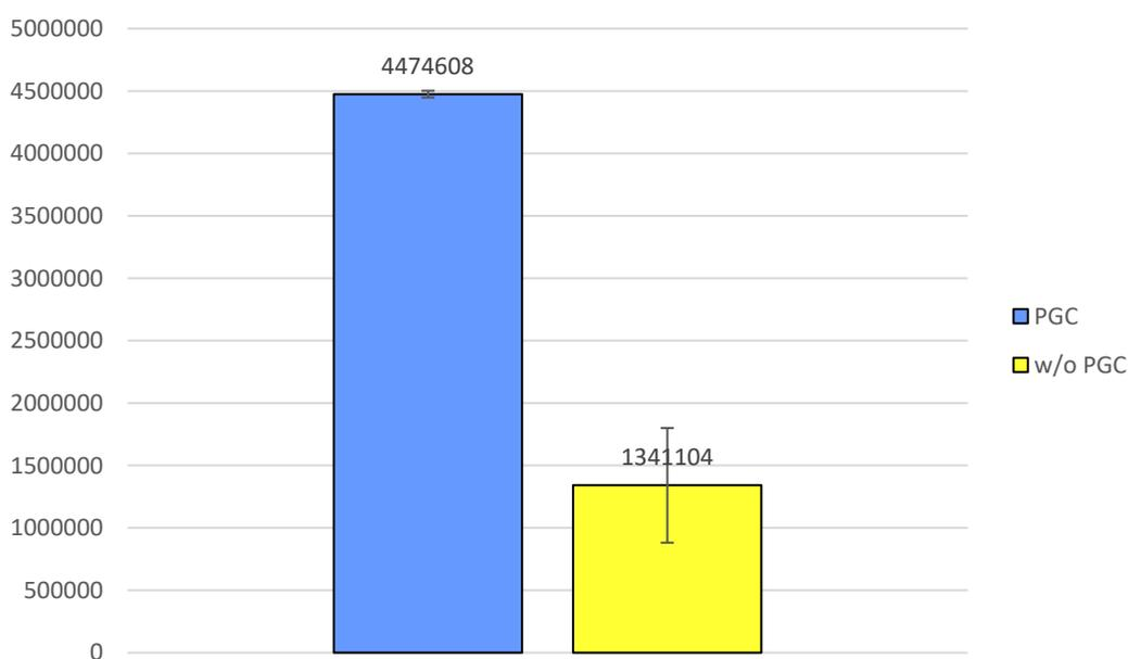
**Slika 17.** Površina glavnog vrška izoliranog IgG čiji su glikani obilježeni 2-AB-om i ProA-om te ukoncentriranog PGC-om (PGC; plava boja) u odnosu na površinu vršaka neukoncentriranog izoliranog IgG (w/o PGC; žuta boja) čiji su glikani obilježeni istim bojama. Za 2-AB prikazane su izmjerene površine vršaka za početnu koncentraciju IgG-a od 5  $\mu$ g, a za ProA za početnu koncentraciju IgG-a od 1  $\mu$ g.
