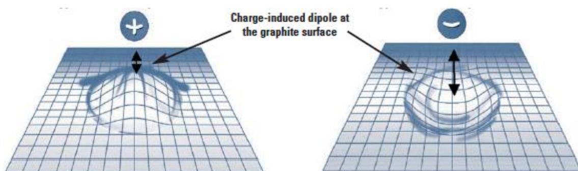
**Slika 5. Indukcija naboja na polarizabilnoj površini PGC kolone polarnim analitom.** Preuzeto i prilagođeno s Insung HypercarbColumns, [http://www.insungcolumns.com/catgdown\\_bland.php?cmd=view&rno=85](http://www.insungcolumns.com/catgdown_bland.php?cmd=view&rno=85), pristupljeno 8.4.2018.
