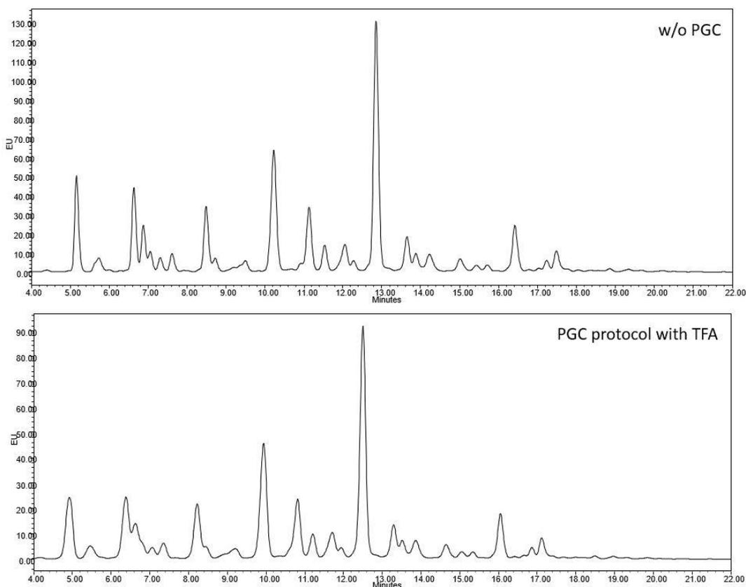
**Slika 8. Usporedba kromatograma dobivenih UPLC analizom uzoraka pripremljenih bez PGC-a (gornji kromatogram, w/o PGC) i s PGC-om uz dodatak TFA (donji kromatogram, PGC protocol with TFA). Kod uzoraka pripremljenih PGC protokolom uz dodatak TFA došlo je do širenja vršaka, osobito na početnom dijelu kromatograma. Dodatak TFA također je utjecao na retencijsko vrijeme.**
