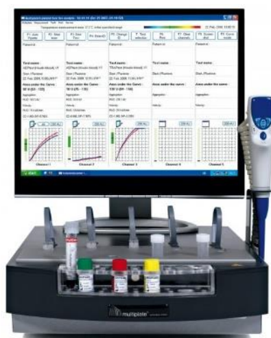
Slika 5: Multiplate® Analyzer (Roche,Switzerland) za provedbu agregacije trombocita. Preuzeto iz www.diagnostics.roche.com
