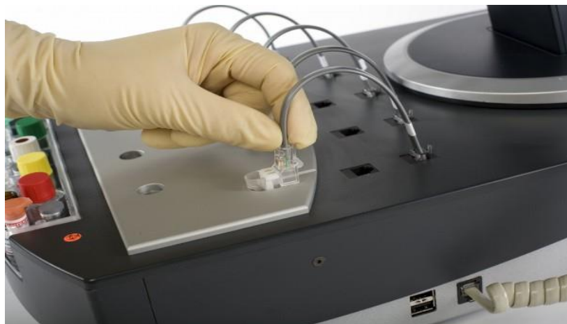
Slika 6A: Provedba testa agregacije: A) stavljanje kivete s dva para nezavisnih elektroda i magnetskim mješačem u inkubacijski blok analizatora i spajanje na instrument.
