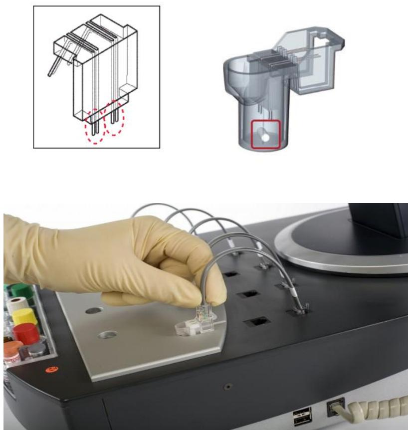
**Slika 6A:** Provedba testa agregacije: A) stavljanje kivete s dva para nezavisnih elektroda i magnetskim mješačem u inkubacijski blok analizatora i spajanje na instrument.
