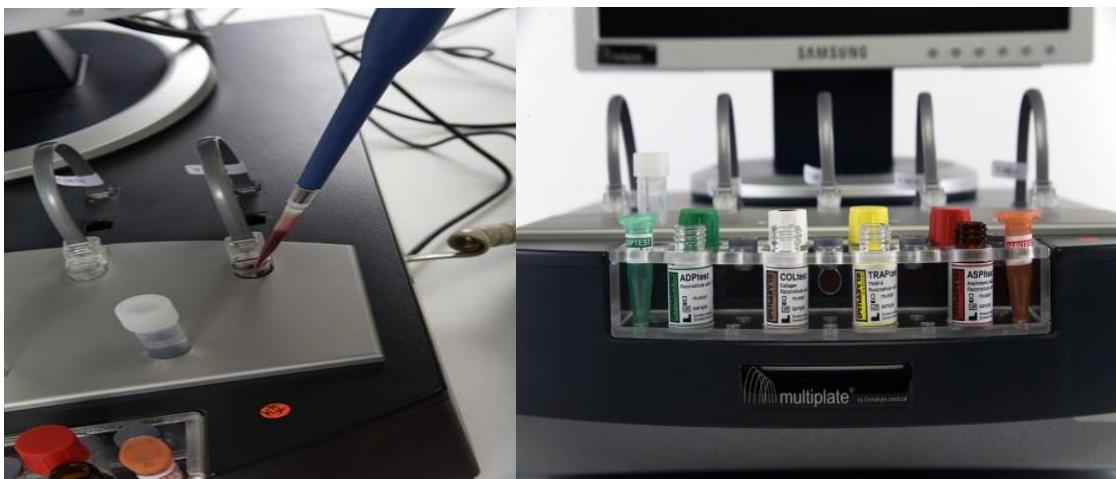
**Slika 6B:** Provedba testa agregacije: B) Stavljanje uzorka krvi, reagensa i induktora agregacije automatskom pipetom u kivetu. Preuzeto iz [www.diapharma.com](http://www.diapharma.com)
