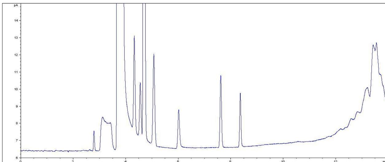
Slika 7. 0,5 % (V/V) onečišćenja u etanolu (30 % (V/V))
