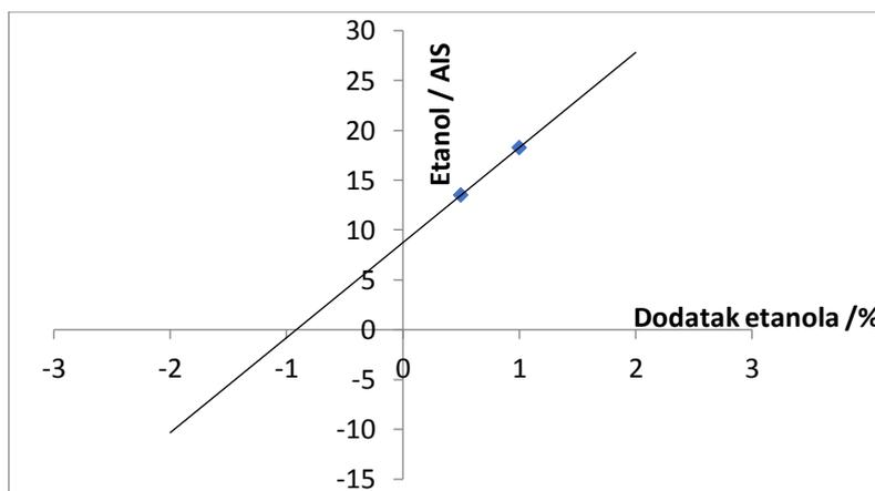
Slika 9. Grafički prikaz dobiven metodom standardnog dodatka
