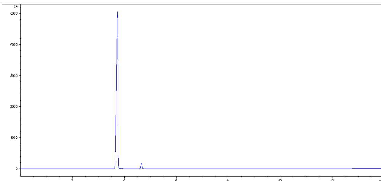
Slika 7. Kromatogram uzorka tinkture kurkume (5%) s acetonitrilom (IS)
