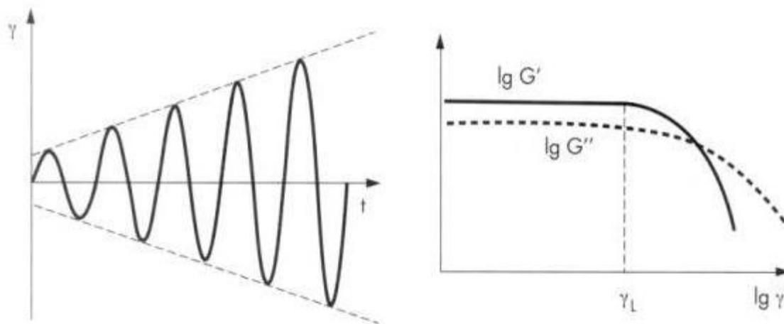
Slika 16. Test promjene amplitude – promjena amplitude pri konstantnoj frekvenciji. Krivulje  $G'$  (modul pohrane) i  $G''$  (modul gubitka) s graničnom vrijednošću  $\gamma_L$  i linearnim viskoelastičnim područjem (LVE) (Jaganath, 2004).
