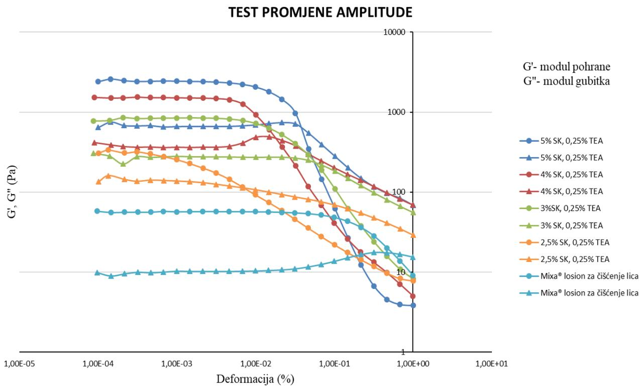
Slika 22. Test promjene amplitude za losione sa različitim udjelom stearinske kiseline (SK) i stalnim udjelom trietanolamina (TEA) od 0,25 % (*m/m*); krivulja G' (●) prikazuje modul pohrane, a G'' (▲) modul gubitka.
