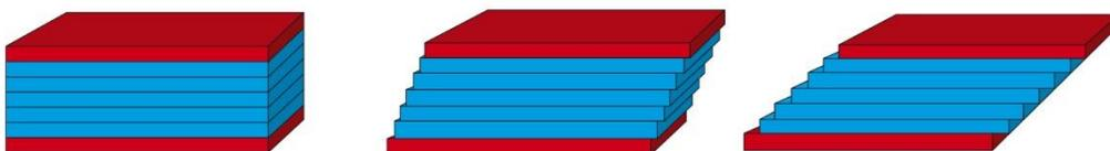
Slika 2. Model s dvije ploče: Smicanje se primjenjuje na uzorak umetnut između dvije ploče kada se pokreće gornja ploča, dok je donja ploča nepomična (www.anton-paar.com).
