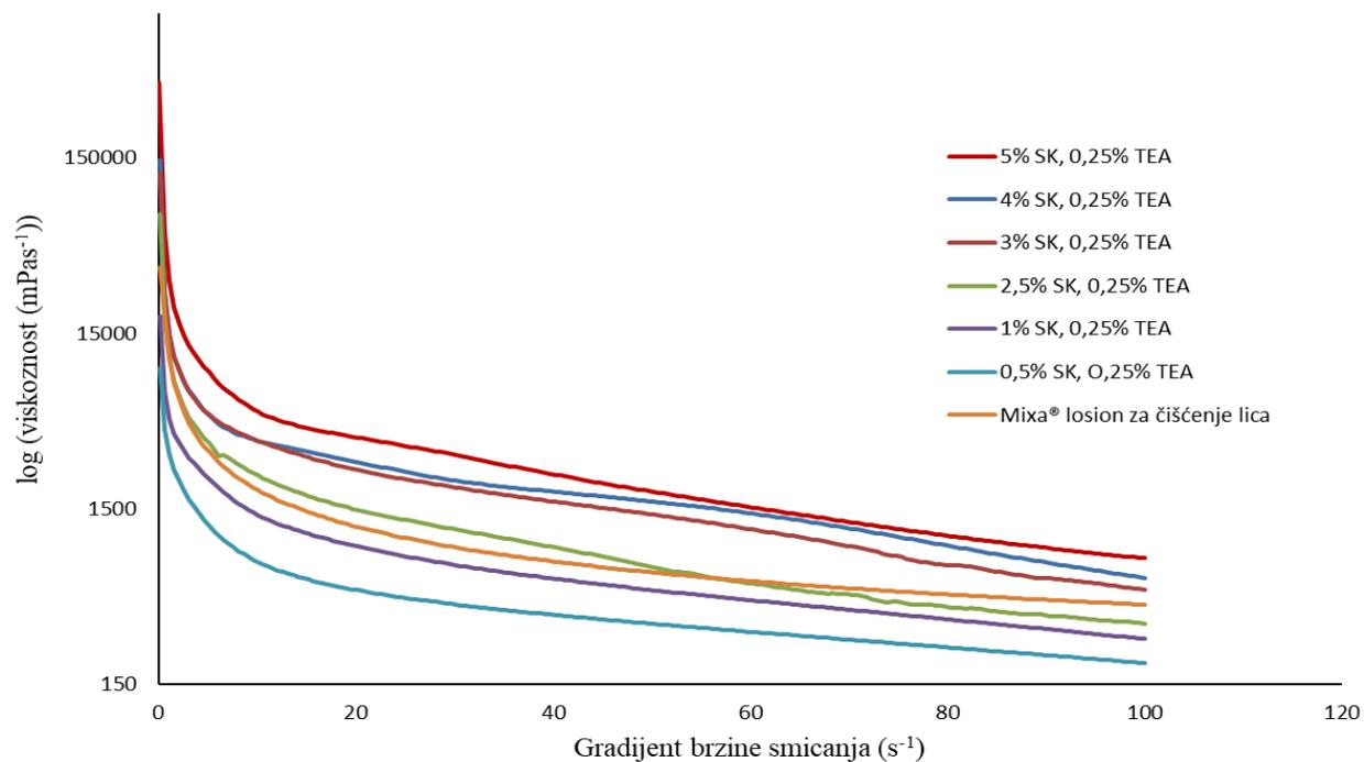
Slika 20. Krivulje ovisnosti prividne viskoznosti o gradijentu brzine smicanja losiona za čišćenje lica u kojima je postupno smanjivan udio stearinske kiseline (SK); udio trietanolamina (TEA) je 0,25 % (m/m); smanjenje % SK uzrokuje smanjenje prividne viskoznosti losiona.
