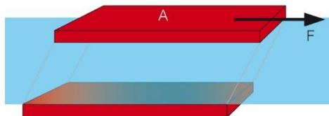
Slika 3. Model s dvije ploče za određivanje smičnog naprezanja korištenjem parametara smične sile  $F$  i površine smicanja  $A$  gornje, pokretne ploče (www.anton-paar.com).
