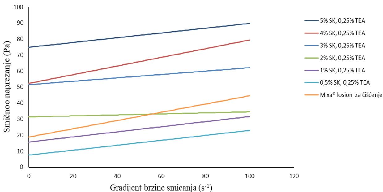
Slika 21. Regresijske krivulje ovisnosti smičnog naprezanja o gradijentu brzine smicanja (po Binghamovom matematičkom modelu) losiona s 0,25 % (*m/m*) trietanolamina (TEA) kojima je postupno smanjivan udio stearinske kiseline (SK); presjek svake krivulje s osi smičnog naprezanja prikazuje vrijednost graničnog smičnog naprezanja ( $\tau_0$ ) za pojedini losion.
