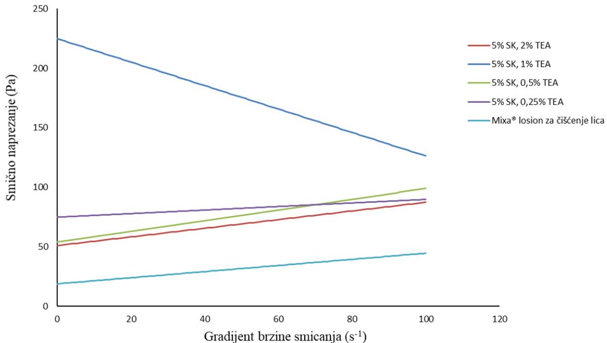
Slika 18. Regresijske krivulje ovisnosti smičnog napreznja o gradijentu brzine smicanja (po Binghamovom matematičkom modelu dobivene korištenjem RheoCompass softvera) losiona kojima je postupno smanjivan udio trietanolamina (TEA); sjecište pojedine krivulje s osi smičnog napreznja predstavlja granično smično napreznje ( $\tau_0$ ) za pojedini losion.
