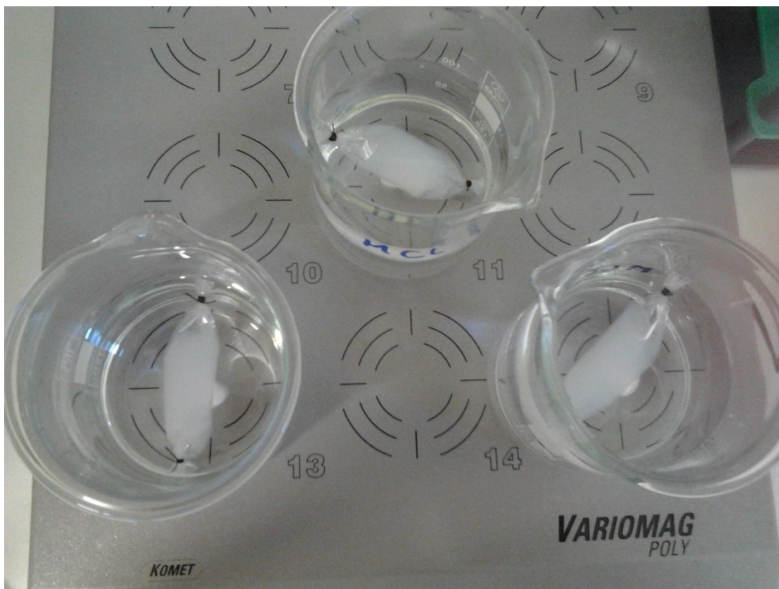
Slika 10. Dijaliza suspenzije nanočestica: odvajanje neuklopljenog lijeka od nanočestica s uklopljenim lijekom
