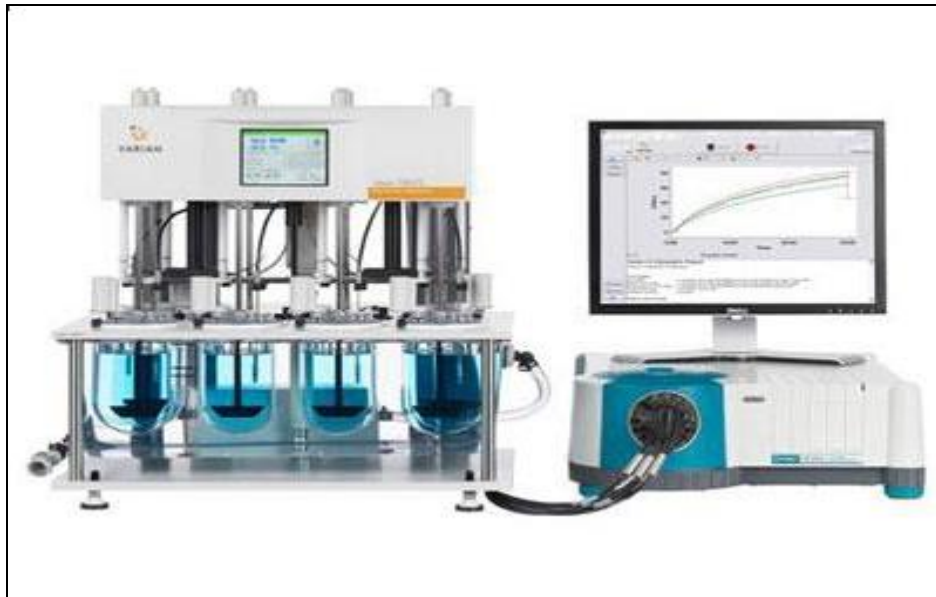
Slika 4. Uređaj za ispitivanje oslobađanja spregnut optičkim vlaknima sa spektrofotometrom (preuzeto s www.labcompare.com )
