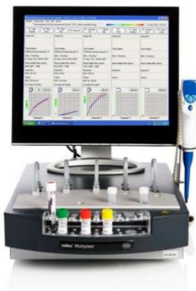
Slika 16. Multiplate® uređaj za praćenje agregacije trombocita.
