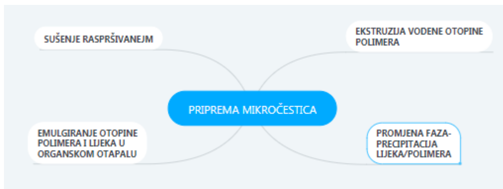
Slika 7. Metode pripreme mikročestica (izrađeno u programu Online mind mapping www.mindmeister.com ) (prilagođeno prema Chowdary i Srinivasa Rao, 2004)
