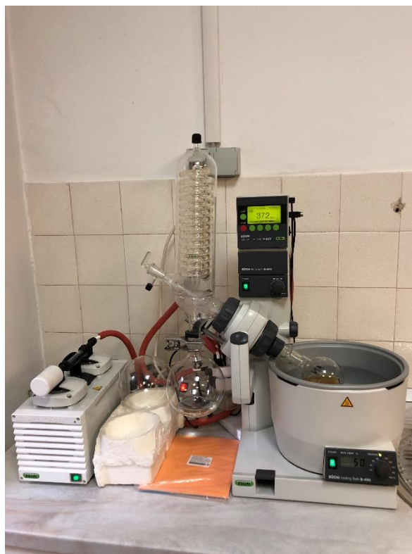
Slika 9. Uparavanje pomoću rotavapora (Fotografija: Anđela Dragaš)
