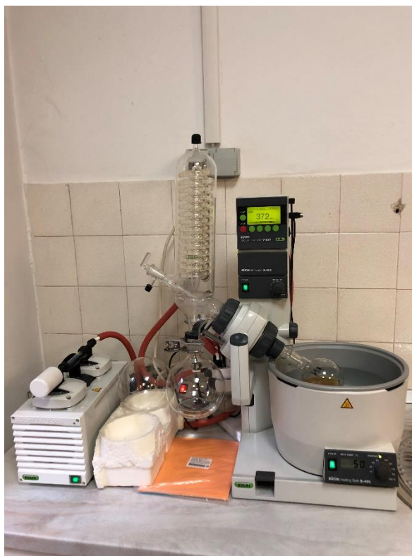
Slika 9. Uparavanje pomoću rotavapora (Fotografija: Anđela Dragaš)
