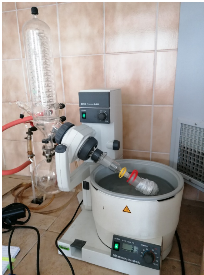
Slika 7. Postupak uparivanja na laboratorijskom rotacionom uparivaču, pri temperaturi 33°C
