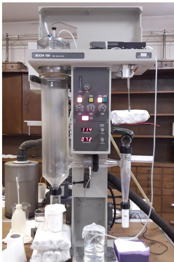
Slika 10. Uređaj za sušenje raspršivanjem Büchi 190 Mini SprayDryer
