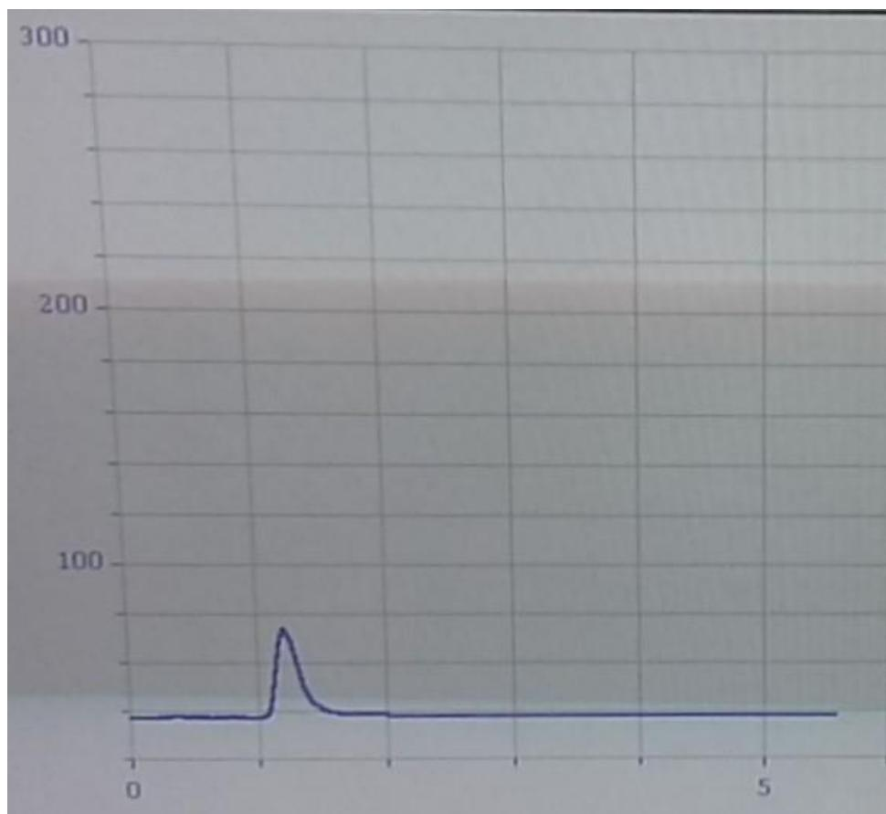
Slika 3. Kromatogram standardne otopine vinske kiseline koncentracije 0,125 g/L dobiven HPLC metodom s UV/Vis detektorom.
