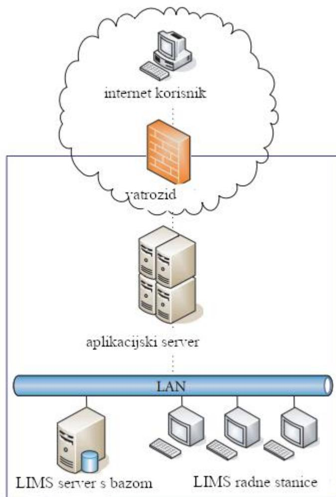
Slika 13. U ovom primjer web-omogućenog LIMS-a vatrozid onemogućava korisnicima Interneta da slobodno pristupaju LIMS aplikacijskom serveru. Unutar LAN<sup>22</sup>-a (Local Area Network) pristup je omogućen svim korisnicima. Na taj način se osigurava pristup web-omogućenom LIMS-u jedino unutar lokalne mreže (prilagođeno prema Ulma i Schlabach, 2005)
