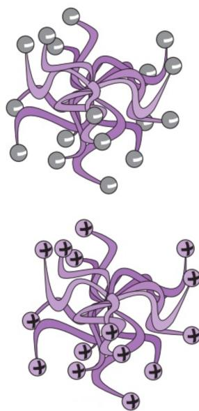
**Slika 5** Shematski prikaz kationske i anionske micele (prilagođeno iz: Heiger D, 2000)
