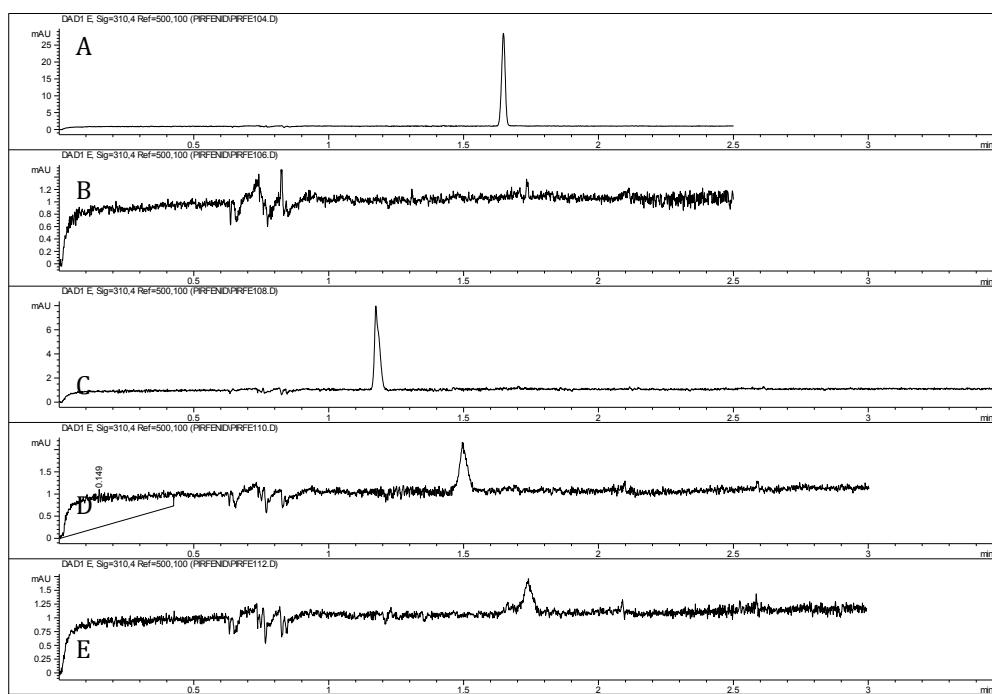
**Slika 15** Elektroferogrami potencijalnih unutarnjih standarda snimljeno na 310 nm.
