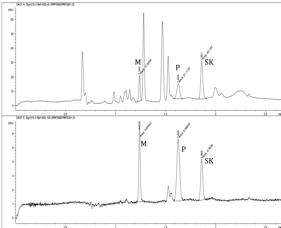
**Slika 25** Elektroferogram obogaćenog biološkog uzorka tkiva, snimljeno UV-Vis detektorom na: (A) 210 nm (B) 310 nm nm – (P) pirfenidon, (M) 5-karboksipirfenidon, (SK) salicilna kiselina
