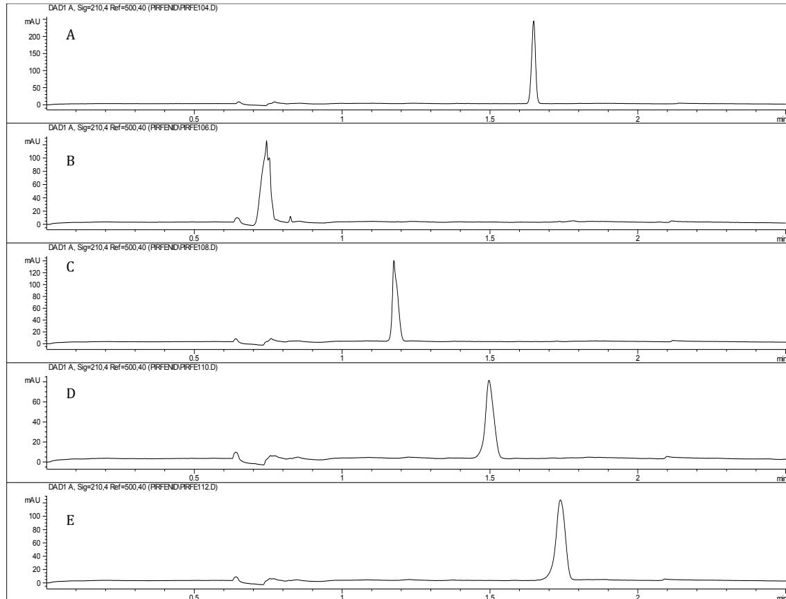
**Slika 14** Elektroferogrami potencijalnih unutarnjih standarda snimljeno na  $210\text{ nm}$ .
