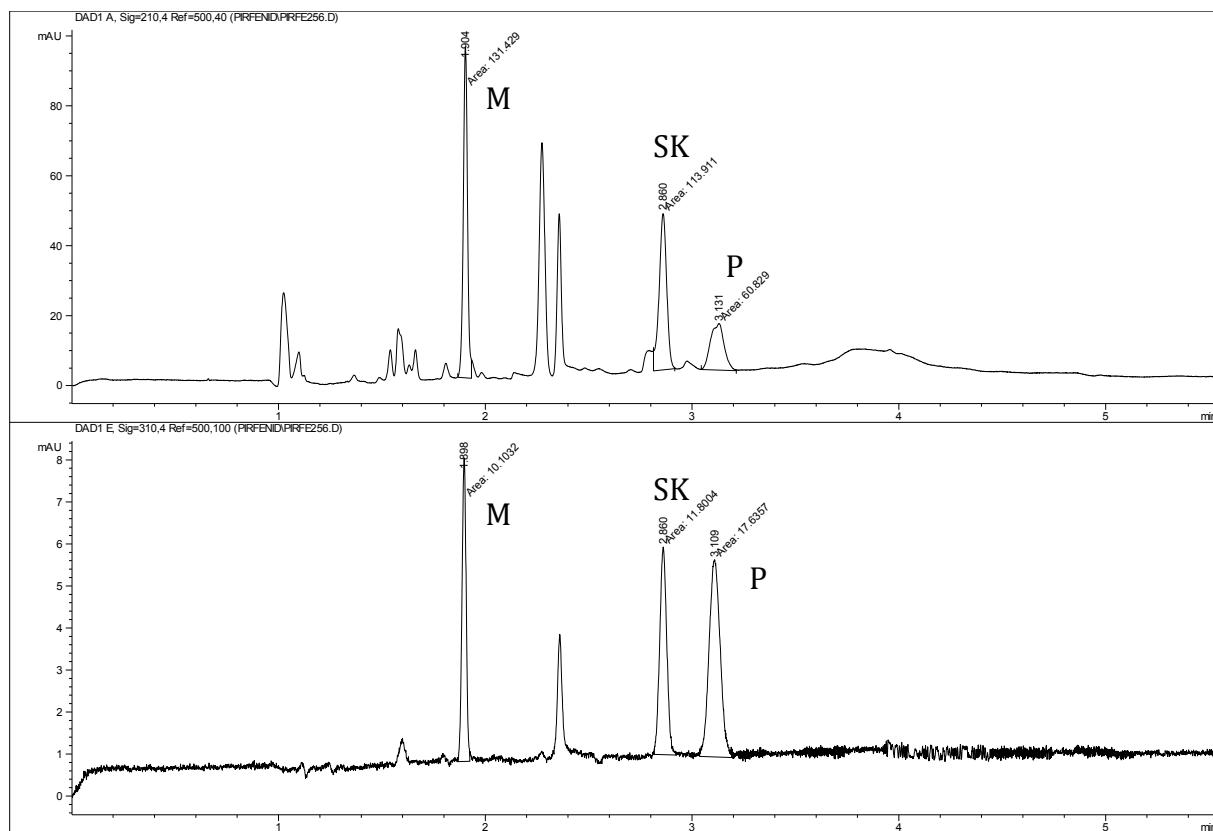
**Slika 24** Elektroferogram obogaćenog biološkog uzorka, snimljeno UV-Vis detektorom na: (A) 210 nm (B) 310 nm – (P) pirfenidon, (M) 5-karboksipifrenidon, (SK) salicilna kiselina
