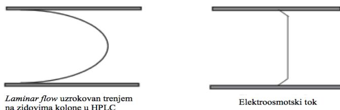
**Slika 4** Usporedba laminarnog toka u HPLC i elektroosmotskog toka u kapilarnoj elektroforezi (Preuzeto iz: Watson 2012.)
