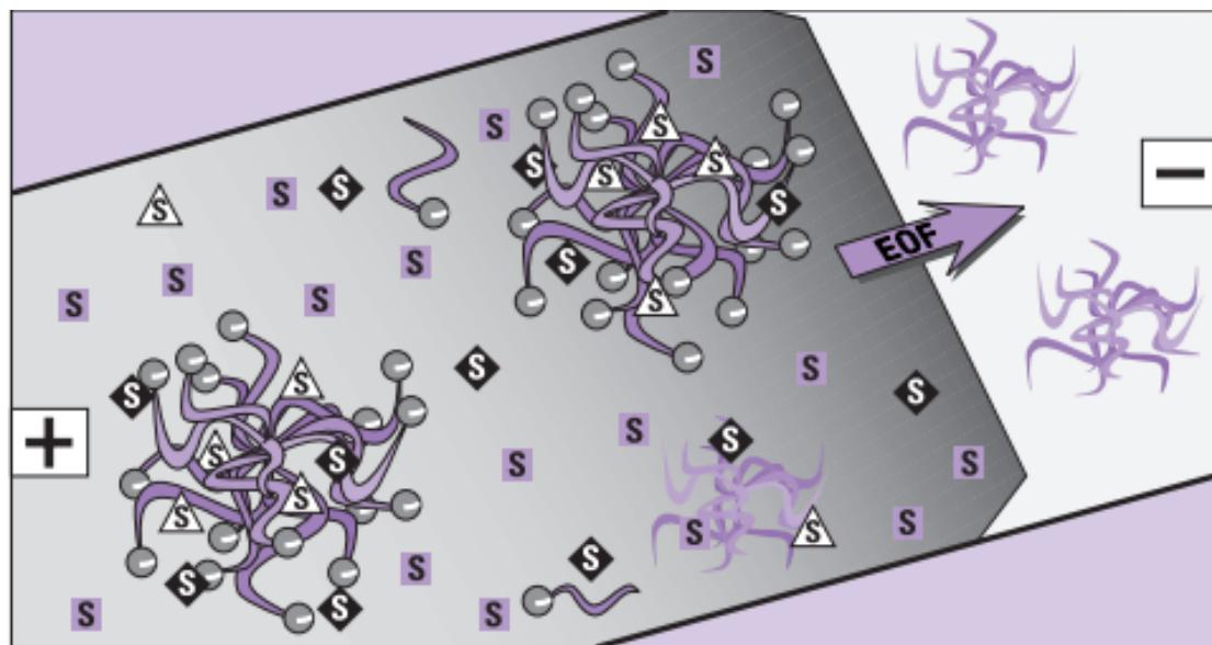
**Slika 6** Shematski prikaz separacije u MEKC. **S u bijelom trokutu** – neutralni analit, **S u rozom kvadratiču** – nabijeni analit (preuzeto iz Heiger D, 2000)
