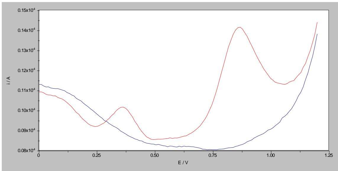
Slika 36. Pravokutnovalni voltamogrami otopine folne kiseline i mesalazina koncentracije  $5 \times 10^{-5}$  M (crveno) i osnovnog elektrolita (plavo) u BR puferu pH 6 na GCE modificiranoj MWCNT/NH<sub>2</sub> (c=2,0 mg/mL) u 0,5 %-tnoj otopini kitozana u 1 %-tnoj octenoj kiselini frekvencije 60Hz, amplitude pulsa 40 mV i promjene porasta potencijala 10 mV,  $E_{pot, me} = 0,36$ V,  $I_{me} = 1,28 \times 10^{-6}$  A,  $E_{pot, fo} = 0,86$  V,  $I_{fo} = 4,04 \times 10^{-6}$  A
