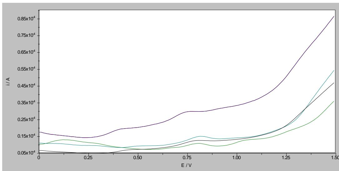
Slika 14. Pravokutnovalni voltamogrami otopine folne kiseline koncentracije  $1 \times 10^{-4}$  M u BR puferu pH 4 (zeleno), pH 6 (cijan), pH 7 (crno) i pH 8 (plavo) na GCE frekvencije 100 Hz, amplituda pulsa 40 mV i promjene porasta potencijala 10 mV
