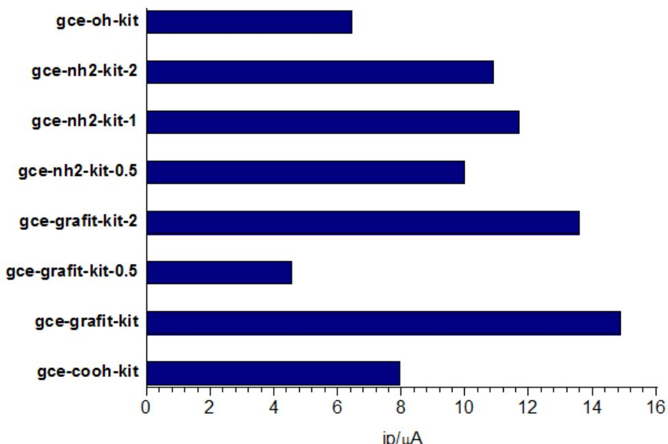
Slika 28. Vršna jakost struje folne kiseline koncentracije  $1 \times 10^{-4}$  M u BR puferu pH 6 izmjerena pravokutnovalnom voltametrijom na modificiranim GCE pri frekvenciji 100 Hz, amplitudi pulsa 40 mV i porastu promjene potencijala 10 mV
