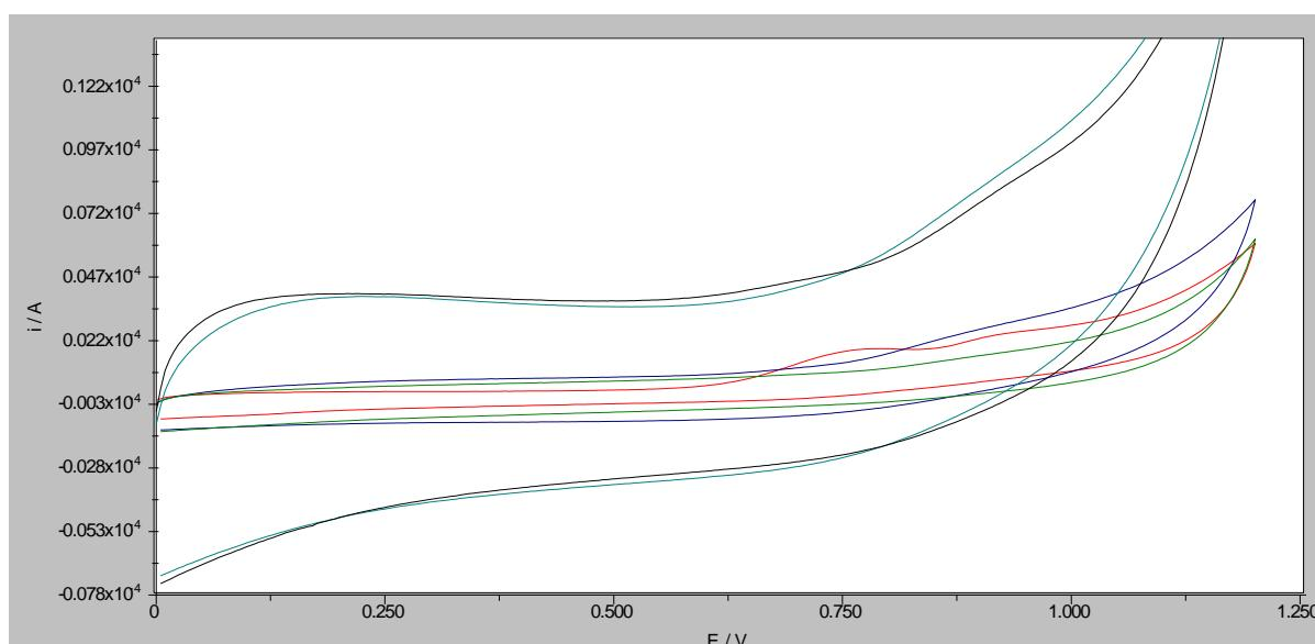
Slika 19. Ciklički voltamogrami otopine folne kiseline koncentracije  $1 \times 10^{-4}$  M u BR puferu pH 6 na nemodificiranoj GCE (crveno) i GCE čija je površina modificirana MWCNT/NH<sub>2</sub> (zeleno), MWCNT/grafit (plavo), MWCNT/OH (cijan) i MWCNT/COOH (crno) (c=1 mg/mL) u 0,3 %-tnoj otopini Nafiona u etanolu pri brzini promjene potencijala 100 mV/s
