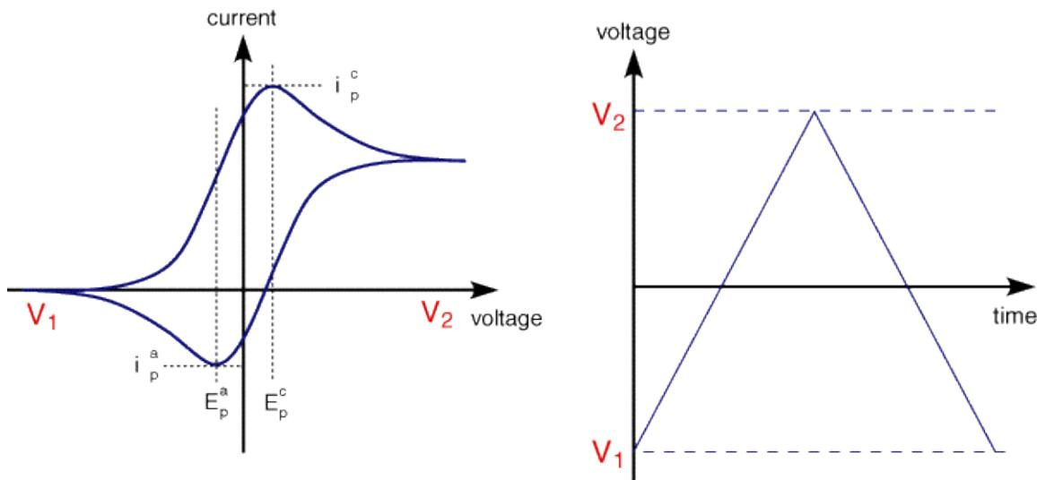
Slika 5. Prikaz signala pobude i odaziva u cikličkoj voltametriji ([www.ceb.cam.ac.uk](http://www.ceb.cam.ac.uk))
