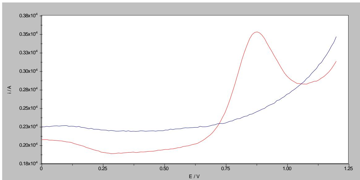
Slika 24. Pravokutnovalni voltamogrami otopine folne kiseline koncentracije  $1 \times 10^{-4} \text{ M}$  u BR puferu pH 6 (crveno) i osnovnog elektrolita (plavo) na GCE čija je površina modificirana MWCNT/NH<sub>2</sub> ( $c=2,0 \text{ mg/mL}$ ) u 0,5 %-tnoj otopini kitozana u 1 %-tnoj octenoj kiselini frekvencije 100 Hz, amplitude pulsa 40 mV i promjene porasta potencijala 10 mV,  $E_{\text{pot}} = 0,87 \text{ V}$ ,  $I = 10,9 \times 10^{-6} \text{ A}$
