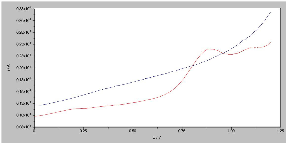
Slika 25. Pravokutnovalni voltamogrami otopine folne kiseline koncentracije  $1 \times 10^{-4}$  M u BR puferu pH 6 (crveno) i osnovnog elektrolita (plavo) na GCE čija je površina modificirana MWCNT/grafit ( $c=0,5$  mg/mL) u 0,5 %-tnoj otopini kitozana u 1 %-tnoj octenoj kiselini frekvencije 100 Hz, amplitude pulsa 40 mV i promjene porasta potencijala 10 mV,  $E_{\text{pot}} =$
