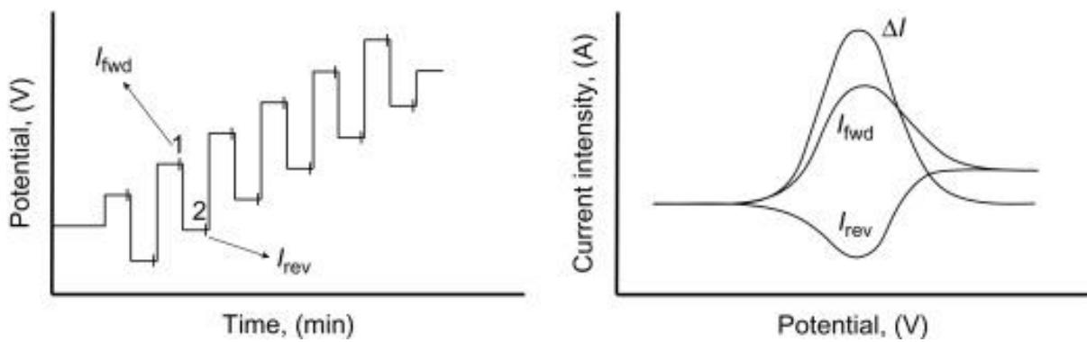
Slika 8. Prikaz pobudnog signala u pravokutnovalnoj voltametriji i pravokutnovalni voltamogram ( $I_{fwd}$  = *forward current intensity*=polazna jakost struje,  $I_{rev}$ =*reverse current intensity*=povratna jakost struje,  $\Delta I=I_{fwd}-I_{rev}$ ) (Dias i sur., 2017)
