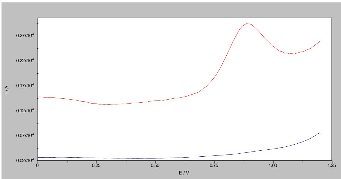
Slika 23. Pravokutnovalni voltamogrami otopine folne kiseline koncentracije  $1 \times 10^{-4} \text{ M}$  u BR puferu pH 6 (crveno) i osnovnog elektrolita (plavo) na GCE čija je površina modificirana MWCNT/NH<sub>2</sub> ( $c=0,5 \text{ mg/mL}$ ) u 0,5 %-tnoj otopini kitozana u 1 %-tnoj octenoj kiselini frekvencije 100 Hz, amplitude pulsa 40 mV i promjene porasta potencijala 10 mV,  $E_{\text{pot}} = 0,89 \text{ V}$ ,  $I = 10,0 \times 10^{-6} \text{ A}$
