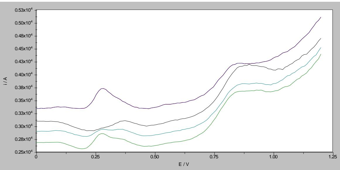
Slika 33. Pravokutnovalni voltamogrami otopine folne kiseline i mesalazina koncentracije  $5 \times 10^{-5}$  M u BR puferu pH 6 na GCE modificiranoj MWCNT/NH<sub>2</sub> (c=1,0 mg/mL) u 0,5 %-tnoj otopini kitozana u 1 %-tnoj octenoj kiselini promjene porasta potencijala 10 mV, amplitude pulsa 40 mV i frekvencije 70 Hz (zeleno), 80 Hz (cijan), 90 Hz (crno) i 100 Hz (plavo)
