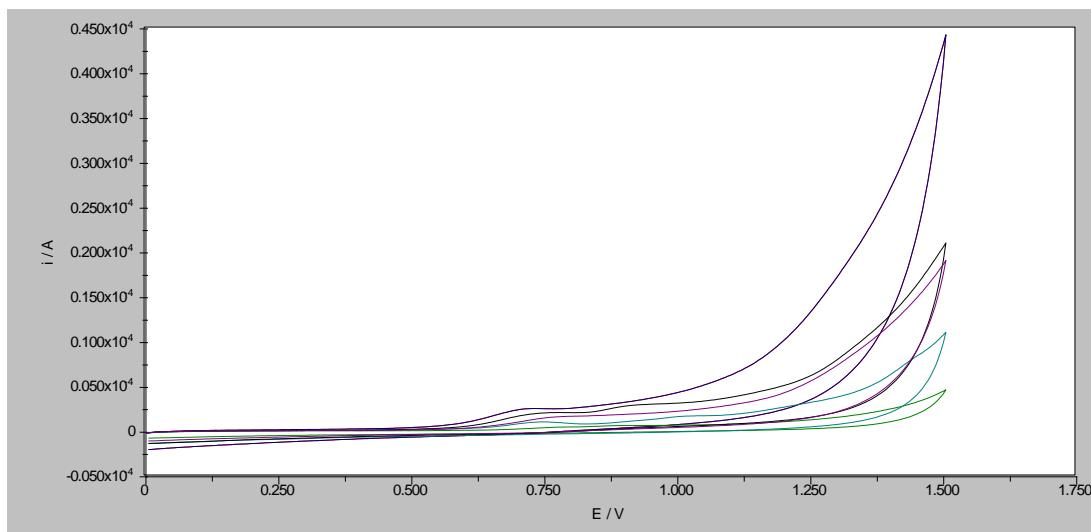
Slika 13. Ciklički voltamogrami otopine folne kiseline koncentracije  $1 \times 10^{-4}$  M u BR puferu pH 2 (zeleno), pH 4 (cijan), pH 6 (crno), pH 7 (magenta) i pH 8 (plavo) na GCE pri brzini promjene potencijala 100 mV/s
