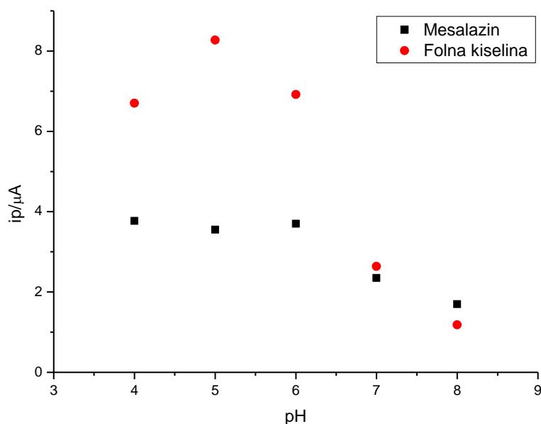
Slika 40. Ovisnost vršne jakosti struje ( $i_p$ ) mesalazina i folne kiseline koncentracije  $5 \times 10^{-5}$  M u BR puferu mjerene na GCE modificiranoj MWCNT/NH<sub>2</sub> ( $c=1,0$  mg/mL) u 0,5 %-tnoj otopini kitozana u 1 %-tnoj octenoj kiselini frekvencije 100 Hz, amplituda pulsa 40 mV i promjene porasta potencijala 10 mV ovisno o promjeni pH
