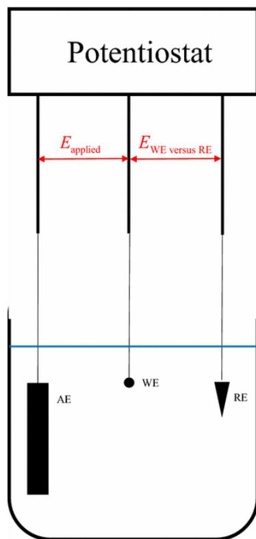
Slika 3. Elektrokemijski članak s tri elektrode i potenciostatom ([link.springer.com](http://link.springer.com)),  $E_{\text{Applied}}$ -primjenjeni napon,  $E_{\text{WE}}$ -radna elektroda,  $E_{\text{RE}}$ -referentna elektroda,  $E_{\text{AE}}$ -pomoćna elektroda
