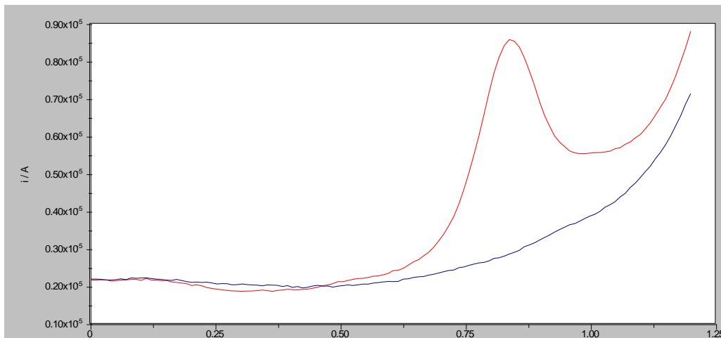
Slika 18. Pravokutnovalni voltamogram otopine folne kiseline koncentracije  $1 \times 10^{-4}$  M u BR puferu pH 6 (crveno) i osnovnog elektrolita (plavo) na GCE fekvencije 100 Hz, amplitude pulsa 40 mV i promjene porasta potencijala 10 mV,  $E_{\text{pot}} = 0,84$  V,  $I = 4,52 \times 10^{-6}$  A
