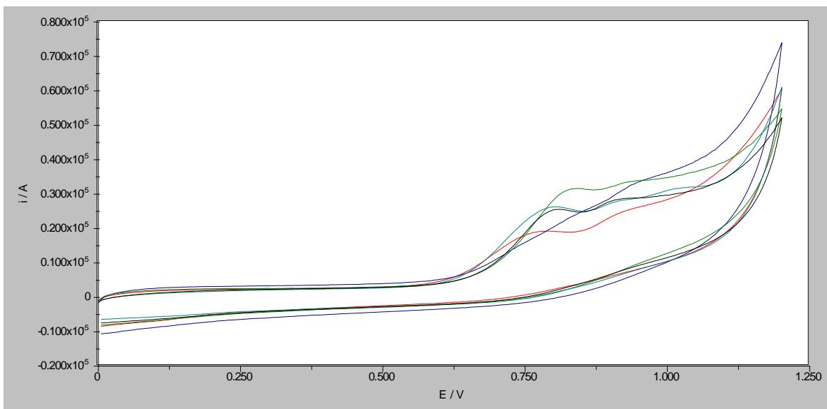
Slika 21. Ciklički voltamogrami otopine folne kiseline koncentracije  $1 \times 10^{-4}$  M u BR pufetu pH 6 na nemodificiranoj GCE (crveno) i GCE čija je površina modificirana MWCNT/NH<sub>2</sub> (crno), MWCNT/grafit (cijan), MWCNT/OH (plavo) i MWCNT/COOH (zeleno) ( $c=1$  mg/mL) u 0,5 %-tnoj otopini kitozana u 1 %-tnoj octenoj kiselini pri brzini promjene potencijala 100 mV/s
