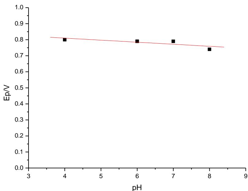
Slika 15. Ovisnost vršnog potencijala folne kiseline koncentracije  $1 \times 10^{-4}$  M u BR puferu mjereno na nemodificiranoj GCE frekvencije 100 Hz, amplitudu pulsa 40 mV i promjene porasta potencijala 10 mV ovisno o promjeni pH
