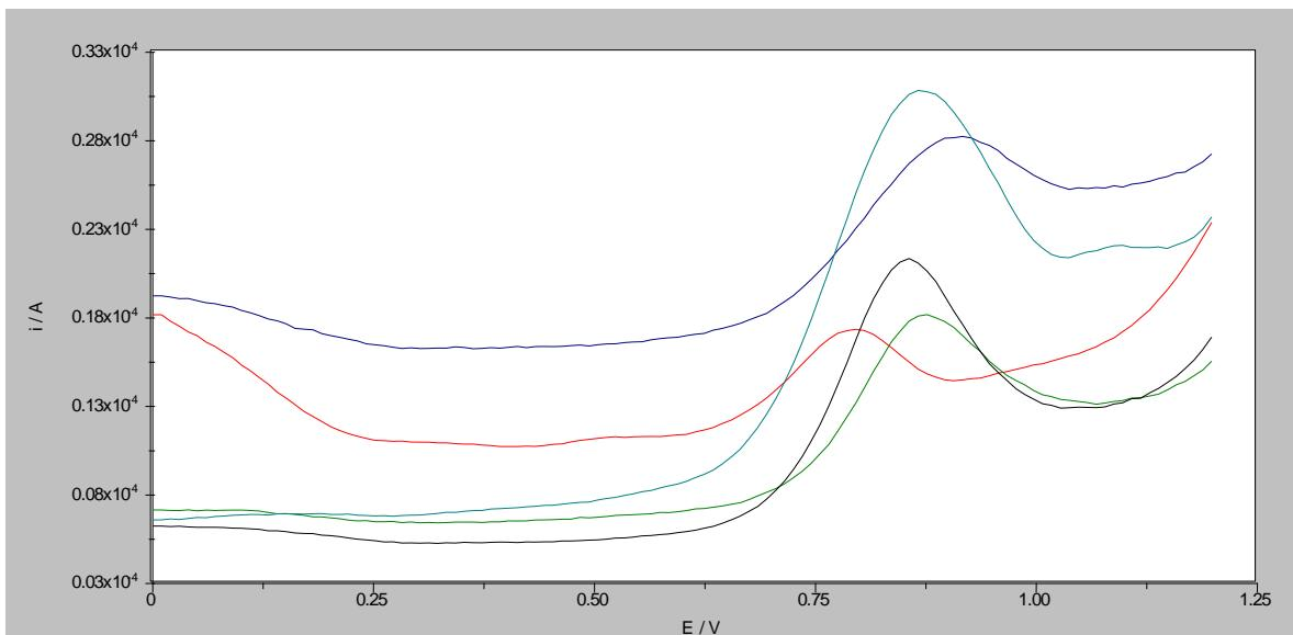
Slika 22. Pravokutnovalni voltamogram otopine folne kiseline koncentracije  $1 \times 10^{-4}$  M u BR pufferu pH 6 na nemodificiranoj GCE (crveno) i GCE čija je površina modificirana MWCNT/NH<sub>2</sub> (crno), MWCNT/grafit (cijan), MWCNT/OH (plavo) i MWCNT/COOH (zeleno) ( $c=1$  mg/mL) u 0,5 %-tnoj otopini kitozana u 1 %-tnoj octenoj kiselini frekvencije 100 Hz, amplitude pulsa 40 mV i promjene porasta potencijala 10 mV
