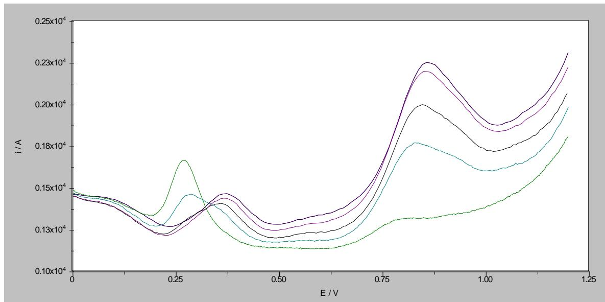
Slika 34. Pravokutnovalni voltamogrami otopine folne kiseline i mesalazina koncentracije  $5 \times 10^{-5}$  M u BR puferu pH 6 na GCE modificiranoj MWCNT/NH<sub>2</sub> (c=1,0 mg/mL) u 0,5 %-tnoj otopini kitozana u 1 %-tnoj octenoj kiselini frekvencije 85 Hz, amplitude pulsa 40 mV i promjene porasta potencijala 2 mV (zeleno), 4 mV (cijan), 6 mV (crno), 8 mV (magenta), 10 mV (plavo)
