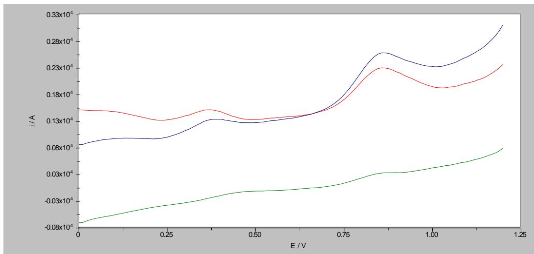
Slika 31. Pravokutnovalni voltamogrami otopine folne kiseline i mesalazina koncentracije  $5 \times 10^{-5}$  M u BR puferu pH 6 na nemodificiranoj GCE (plavo) i modificiranoj MWCNT/NH<sub>2</sub> (c=2,0 mg/mL) (crveno) u 0,5 %-tnoj otopini kitozana u 1 %-tnoj octenoj kiselini te povratni odaziv (zeleno) frekvencije 100 Hz, amplitude pulsa 40 mV i promjene porasta potencijala 10 mV
