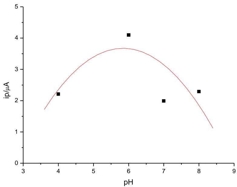
Slika 16. Ovisnost vršne jakosti struje ( $i_p$ ) folne kiseline koncentracije  $1 \times 10^{-4}$  M u BR puferu mjerene na nemodificiranoj GCE frekvencije 100 Hz, amplitude pulsa 40 mV i promjene porasta potencijala 10 mV ovisno o promjeni pH
