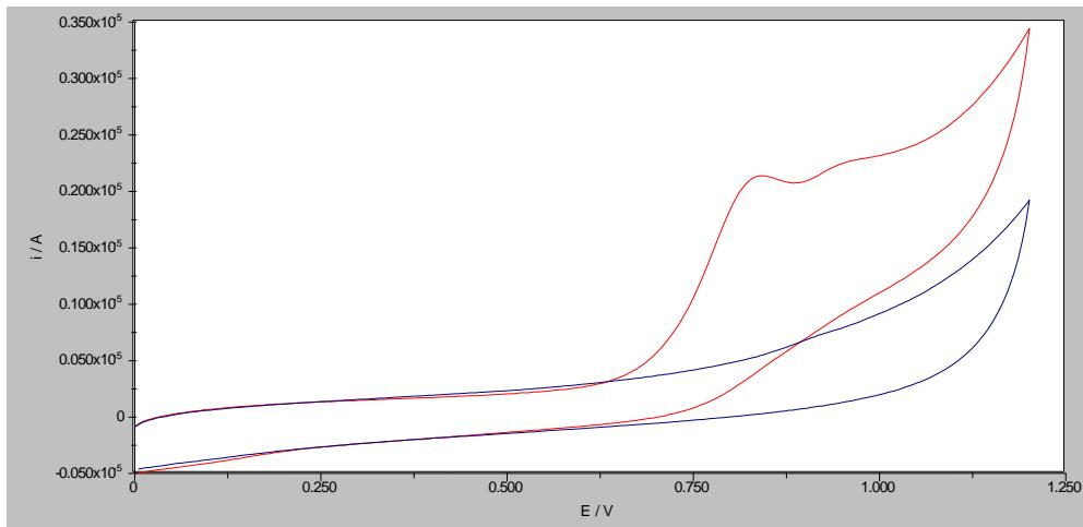
Slika 17. Ciklički voltamogram otopine folne kiseline koncentracije  $1 \times 10^{-4}$  M u BR puferu pH 6 (crveno) i osnovnog elektrolita (plavo) na GCE pri brzini promjene potencijala 100 mV/s,
