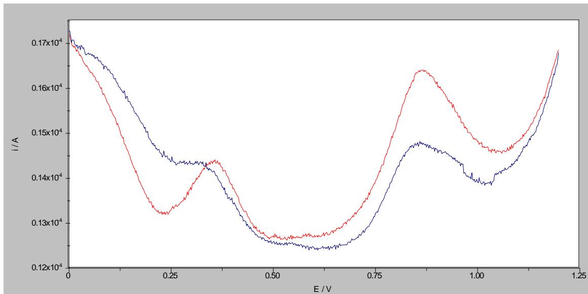
Slika 35. Pravokutnovalni voltamogrami otopine folne kiseline i mesalazina koncentracije  $5 \times 10^{-5}$  M (crveno) i osnovnog elektrolita (plavo) u BR puferu pH 6 na GCE modificiranoj MWCNT/NH<sub>2</sub> ( $c=2,0$  mg/mL) u 0,5 %-tnoj otopini kitozana u 1 %-tnoj octenoj kiselini frekvencije 100 Hz, amplitude pulsa 40 mV i promjene porasta potencijala 2 mV,  $E_{pot, me}=0,36$  V,  $I_{me}=1,43 \times 10^{-6}$  A,  $E_{pot, fo}=0,86$  V,  $I_{fo}=2,66 \times 10^{-6}$  A
