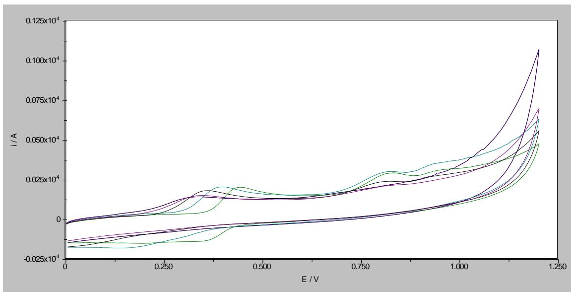
Slika 37. Ciklički voltamogrami otopine folne kiseline i mesalazina koncentracije  $5 \times 10^{-5}$  M u BR puferu pH 4 (zeleno), 5 (cijan), 6 (crno), 7 (magenta) i 8 (plavo) na GCE modificiranoj MWCNT/NH<sub>2</sub> ( $c=1,0$  mg/mL) u 0,5 %-tnoj otopini kitozana u 1 %-tnoj octenoj kiselini pri brzini promjene potencijala 100 mV/s
