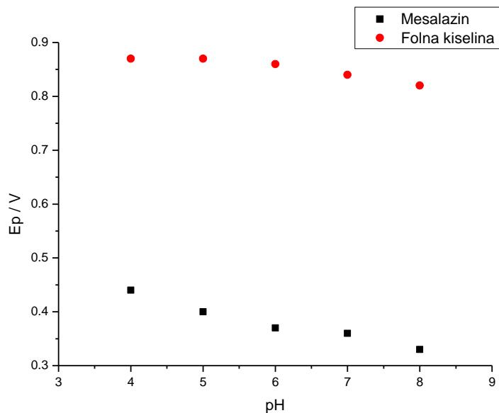
Slika 39. Ovisnost vršnog potencijala mesalazina i folne kiseline koncentracije  $5 \times 10^{-5}$  M u BR puferu mjereno na GCE modificiranoj MWCNT/NH<sub>2</sub> ( $c=1,0$  mg/mL) u 0,5 %-tnoj otopini kitozana u 1 %-tnoj octenoj kiselini frekvencije 100 Hz, amplitude pulsa 40 mV i promjene porasta potencijala 10 mV ovisno o promjeni pH
