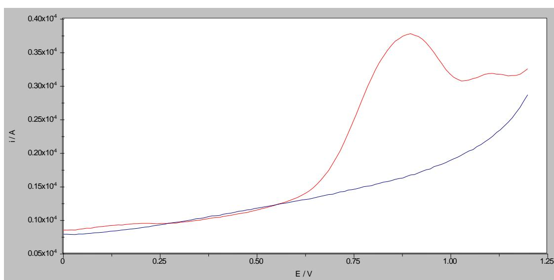
Slika 26. Pravokutnovalni voltamogrami otopine folne kiseline koncentracije  $1 \times 10^{-4}$  M u BR puferu pH 6 (crveno) i osnovnog elektrolita (plavo) na GCE čija je površina modificirana MWCNT/grafit ( $c=2,0$  mg/mL) u 0,5 %-tnoj otopini kitozana u 1 %-tnoj octenoj kiselini frekvencije 100 Hz, amplitude pulsa 40 mV i promjene porasta potencijala 10 mV,  $E_{\text{pot}} =$
