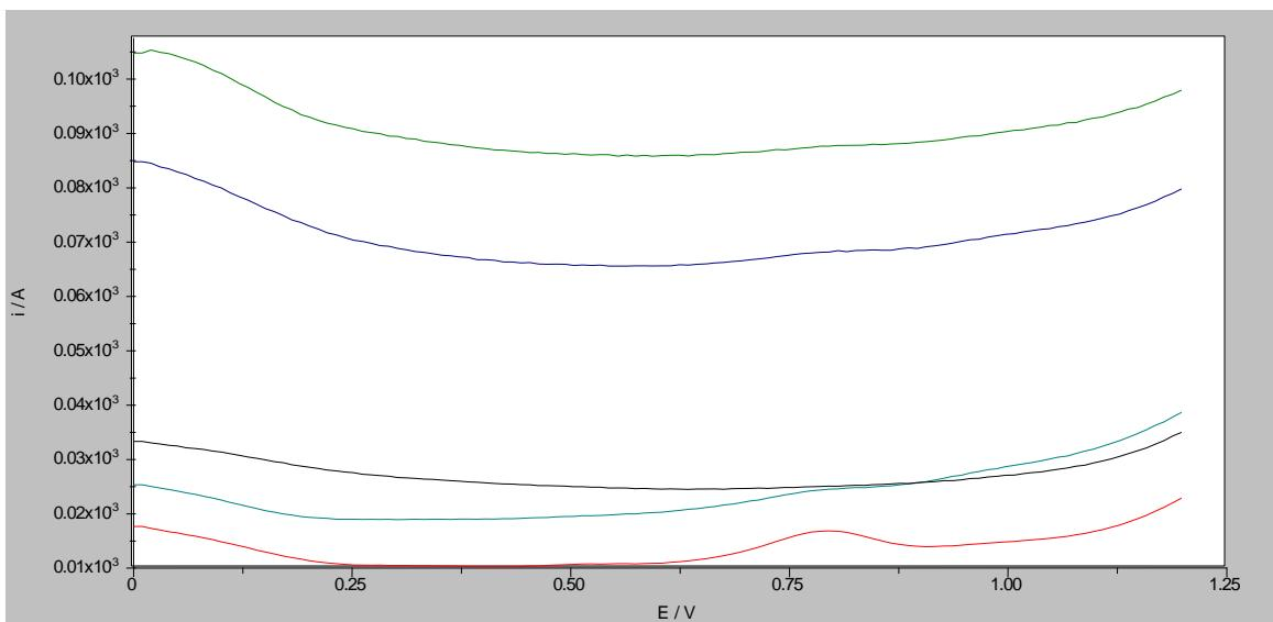
Slika 20. Pravokutnovalni voltamogram otopine folne kiseline koncentracije  $1 \times 10^{-4}$  M u BR pufetu pH 6 na nemodificiranoj GCE (crveno) i GCE čija je površina modificirana MWCNT/NH<sub>2</sub> (crno), MWCNT/grafit (cijan), MWCNT/OH (plavo) i MWCNT/COOH (zeleno) ( $c=1$  mg/mL) u 0,3 %-tnoj otopini Nafiona u etanolu frekvencije 100 Hz, amplitude pulsa 40 mV i promjene porasta potencijala 10 mV
