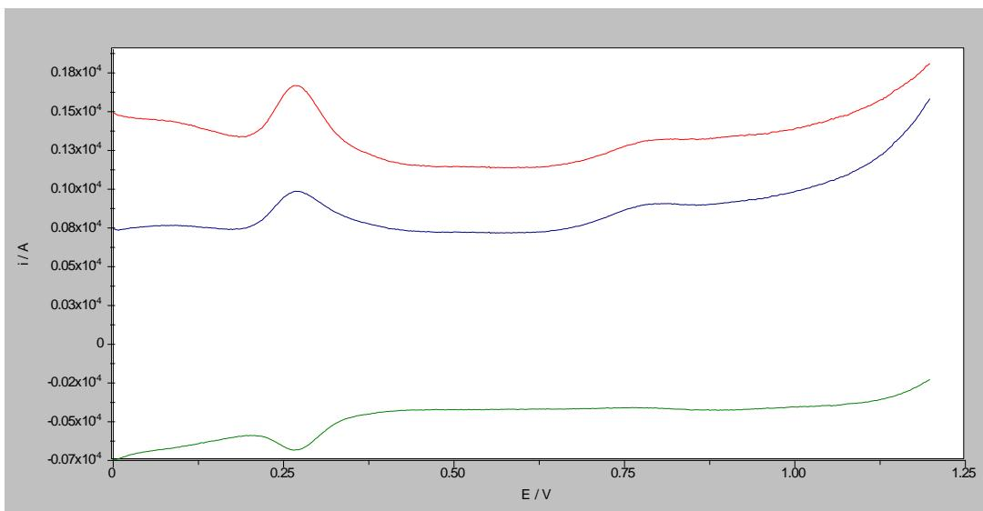
Slika 30. Pravokutnovalni voltamogrami otopine folne kiseline i mesalazina koncentracije  $5 \times 10^{-5}$  M u BR puferu pH 6 na nemodificiranoj GCE (plavo) i modificiranoj MWCNT/NH<sub>2</sub> (c=2,0 mg/mL) (crveno) u 0,5 %-tnoj otopini kitozana u 1 %-tnoj octenoj kiselini te povratni odaziv (zeleno) frekvencije 100 Hz, amplitude pulsa 40 mV i promjene porasta potencijala 2 mV
