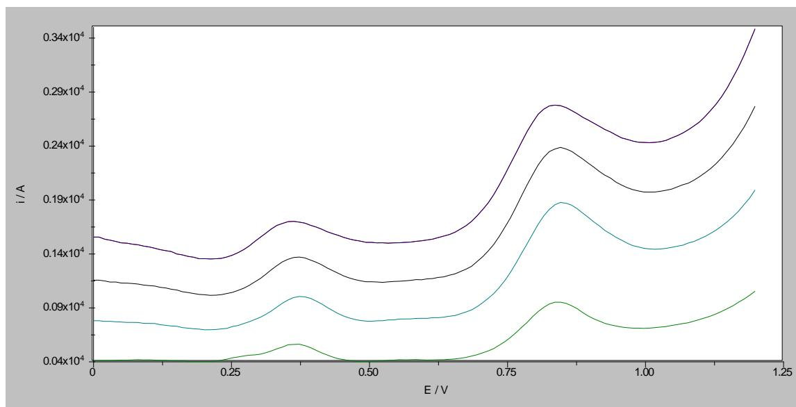
Slika 32. Pravokutnovalni voltamogrami otopine folne kiseline i mesalazina koncentracije  $5 \times 10^{-5}$  M u BR puferu pH 6 na GCE modificiranoj MWCNT/NH<sub>2</sub> (c=1,0 mg/mL) u 0,5 %-tnoj otopini kitozana u 1 %-tnoj octenoj kiselini frekvencije 100 Hz, promjene porasta potencijala 10 mV i amplitude pulsa 20 mV (zeleno), 40 mV (cijan), 60 mV (crno) i 80 mV (plavo)
