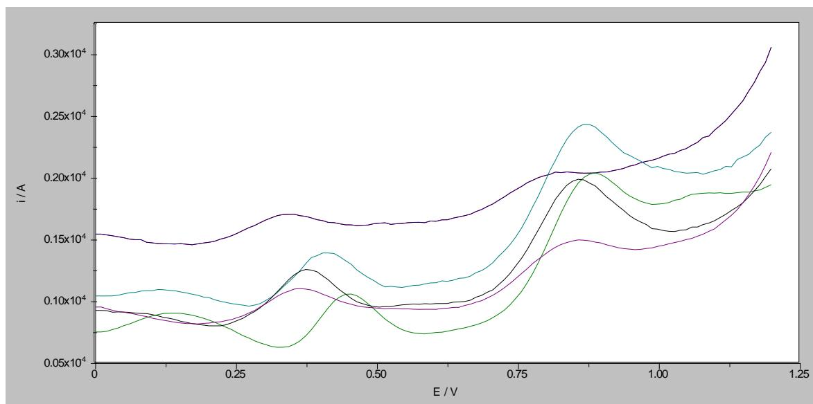
Slika 38. Pravokutnovalni voltamogrami otopine folne kiseline i mesalazina koncentracije  $5 \times 10^{-5}$  M u BR puferu pH 4 (zeleno), 5 (cijan), 6 (crno), 7 (magenta) i 8 (plavo) na GCE modificiranoj MWCNT/NH<sub>2</sub> ( $c=1,0$  mg/mL) u 0,5 %-tnoj otopini kitozana u 1 %-tnoj octenoj kiselini frekvencije 100 Hz, amplitude pulsa 40 mV i promjene porasta potencijala 10 mV
