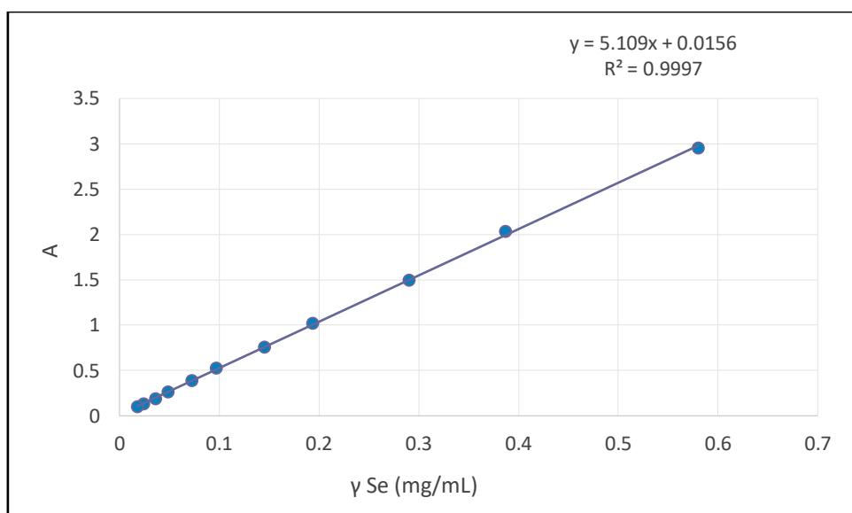
Slika 3. Baždarni dijagram ovisnosti apsorbancije o koncentraciji nanoSe pri valnoj duljini od 405 nm
