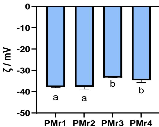
Slika 22. Prikaz zeta potencijala među uzorcima čestica nanoSe inkapsuliranih sirovim pektinima različitih koncentracija
