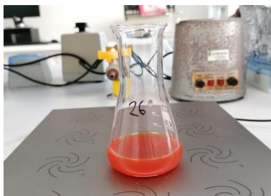
Slika 7. Narančasto obojenje nakon dodatka selenita pri sintezi nanočestica selen (snimljeno prilikom izvođenja eksperimentalnog dijela diplomskog rada)
