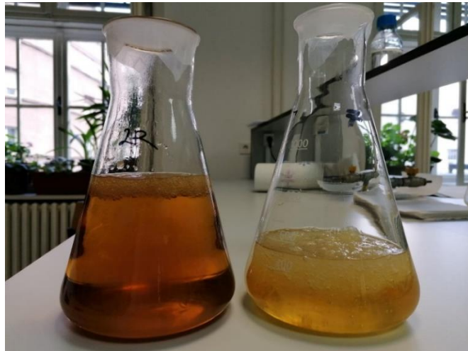
Slika 5. Prikaz precipitiranih pektina (rajčice lijevo, mandarina desno) nakon svih provedenih koraka ekstrakcije (snimljeno prilikom izvođenja eksperimentalnog dijela diplomskog rada)
