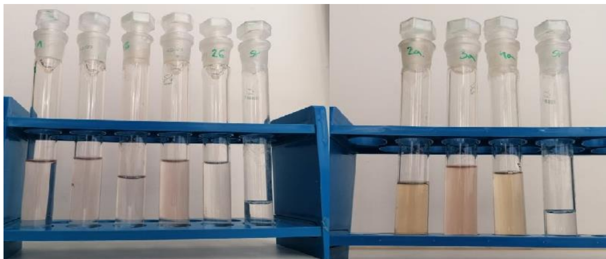
Slika 8. Prikaz uzoraka i slijepe probe nakon digestije (snimljeno prilikom izvođenja eksperimentalnog dijela diplomskog rada)
