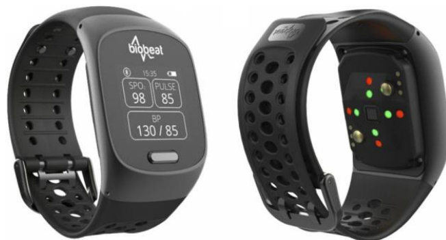
Slika 2. „BioBeat“ nosivi uređaj, prednja i pozadinska strana s vidljivim integriranim PPG senzorima (preuzeto i prilagođeno iz Nachman i sur., 2020).
