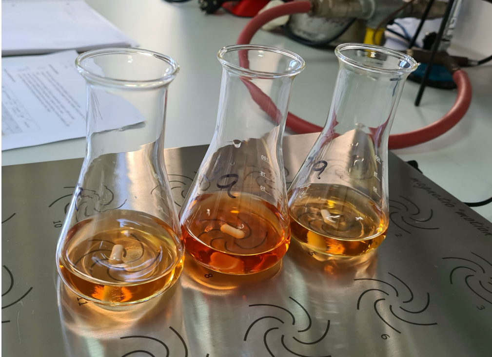
Slika 6: Prikaz sinteze nanoselena (Fotografija: Karla Vitlov)
