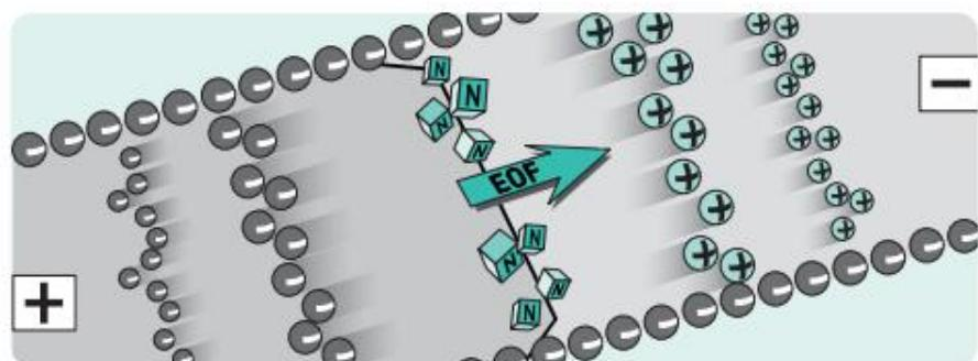
**Slika 4.** Elektroosmotski tok ( preuzeto iz Lauer i Rozing 2014)
