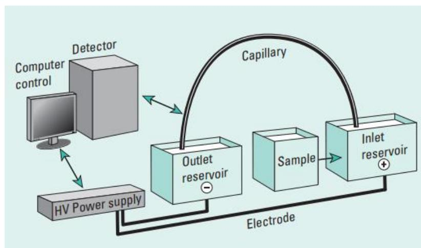
**Slika 2.** Osnovne komponente uređaja za kapilarnu elektroforezu (preuzeto iz: Lauer i Rozing 2014)
