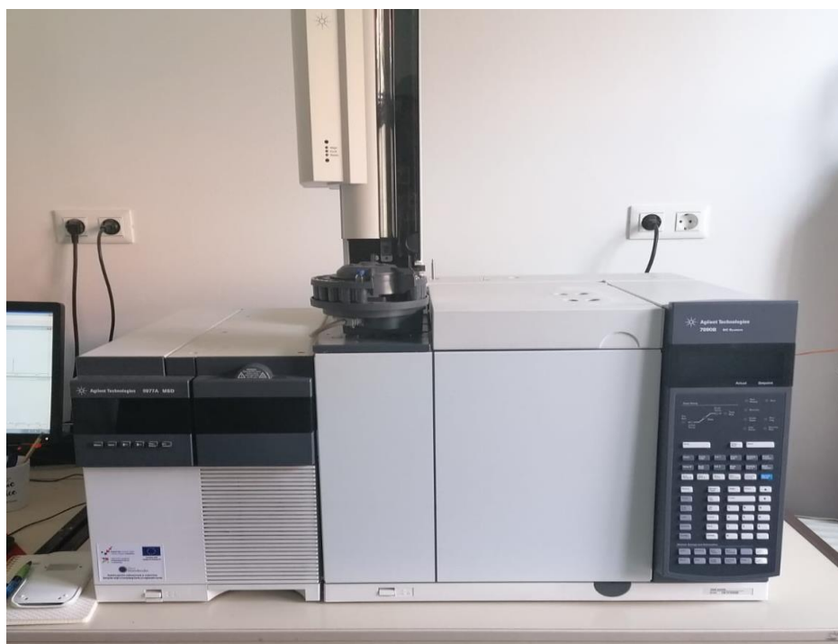
Slika 9. Spregnuti sustav plinski kromatograf – spektrometar masa (GC-MS/MS Agilent 7890B/5977A) na Zavodu za farmakognoziju Farmaceutsko – biokemijskog fakulteta Sveučilišta u Zagrebu
