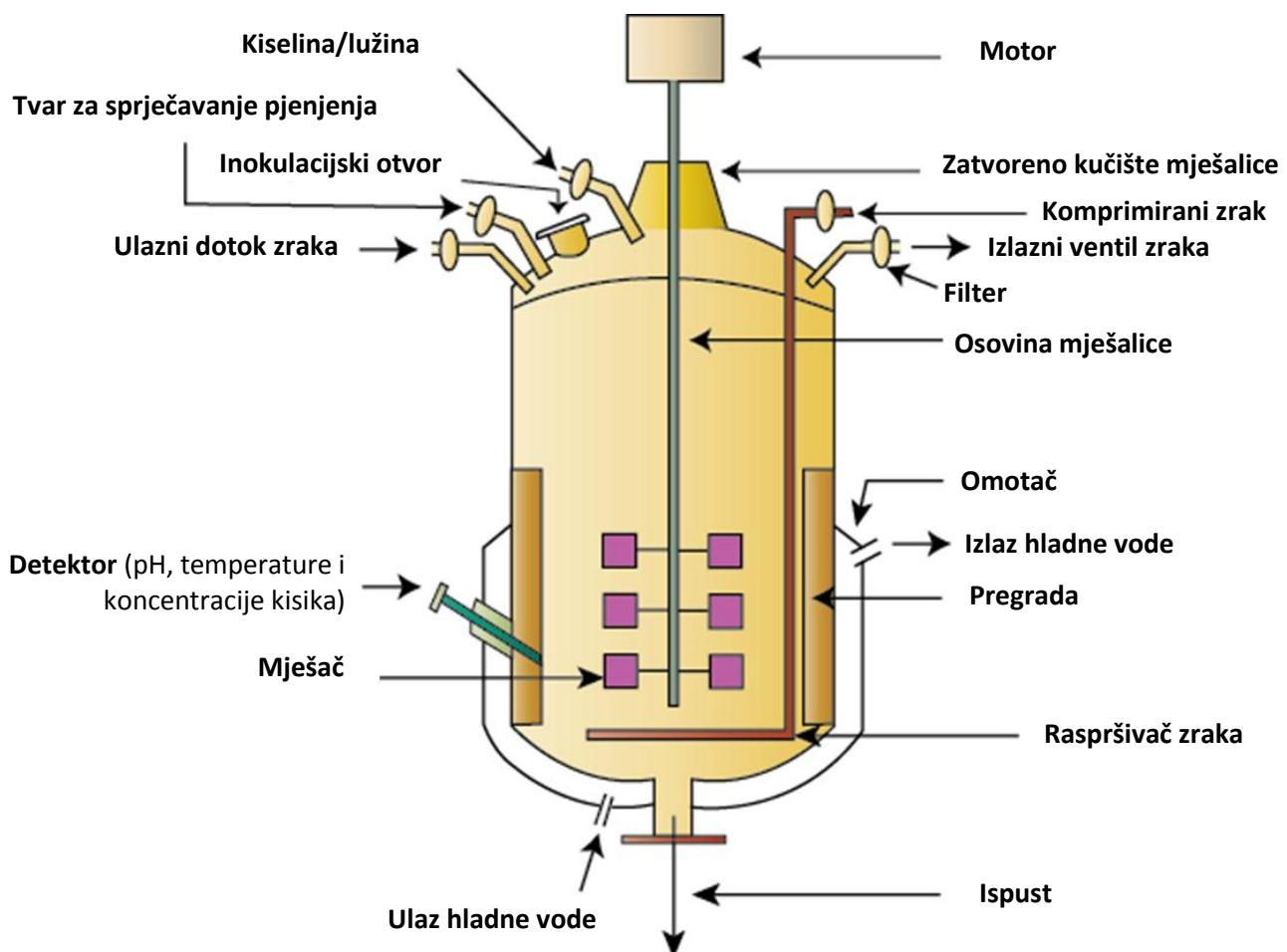
**Slika 3.** Prikaz tipičnog bioreaktora. (Prilagođeno prema: NPTEL, <http://nptel.ac.in/>, preuzeto 23-09-2015.)
