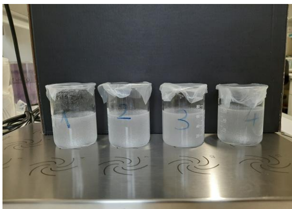
Slika 15. Emulzije s tekućim parafinom i 15% (uzorak 1) / 20% (uzorak 2) / 25 % (uzorak 3) / 30% (uzorak 4) HP-β-CD prije prve homogenizacije
