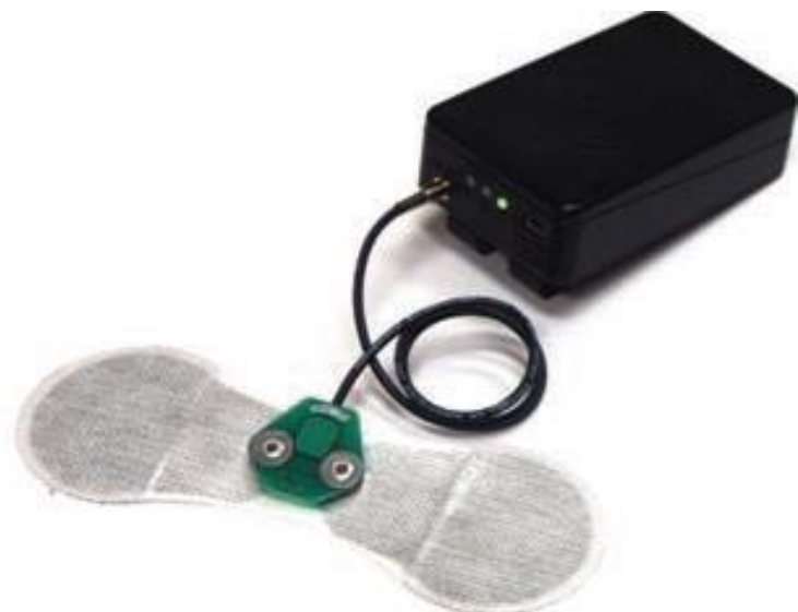
Slika 11. ID-Cap čitač – prima digitalne signale s ID-kapsule i šalje ih u središnju bazu podataka (preuzeto iz Flores i sur., 2016)
