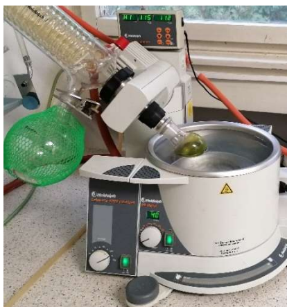
Slika 15. Vakuumsko uparavanje ekstrakta listova vrste Cornus mas
