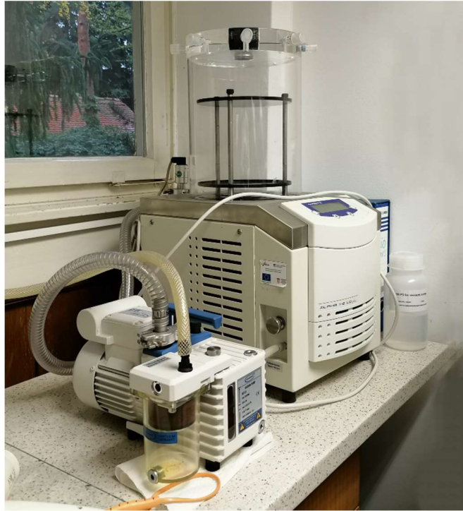
Slika 6. Liofilizator Alpha 1-2 LDplus
