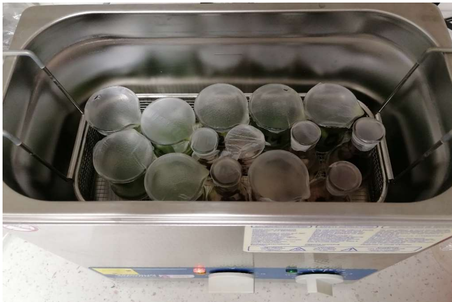
Slika 14. Ultrazvučna ekstrakcija uzoraka drijena
