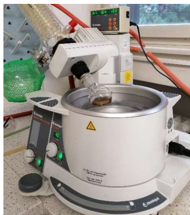
Slika 16. Vakuumsko uparavanje ekstrakta plodova vrste Cornus mas
