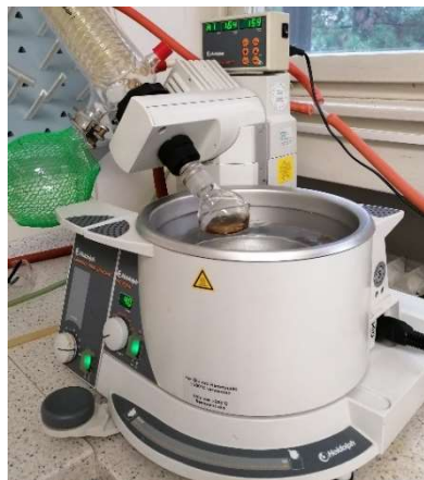
Slika 16. Vakuumsko uparavanje ekstrakta plodova vrste Cornus mas
