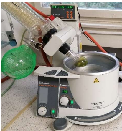
Slika 15. Vakuumsko uparavanje ekstrakta listova vrste Cornus mas
