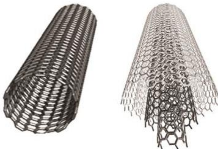
Slika 11. Jednoslojna i višeslojna ugljikova nanocijevčica. ( https://www.researchgate.net/ )
