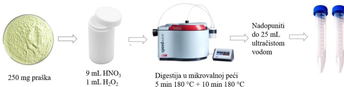
Slika 10. Priprema uzoraka mikrovalnom digestijom (EPA 3052).
