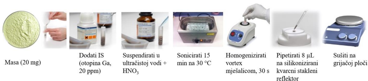
Slika 9. Priprema uzoraka suspendiranjem.
