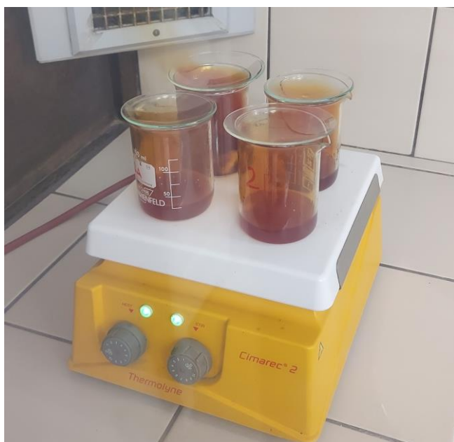
Slika 5. Mokra digestija uzoraka u digestoru
