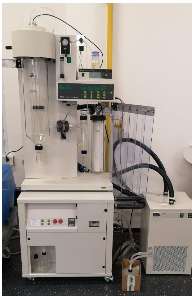
Slika 3. Büchi Mini Spray Drier B-290 s odvlaživačem
