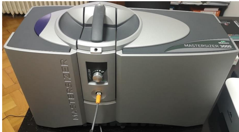
Slika 4. Mastersizer 3000 opremljen Hydro SV ćelijom
