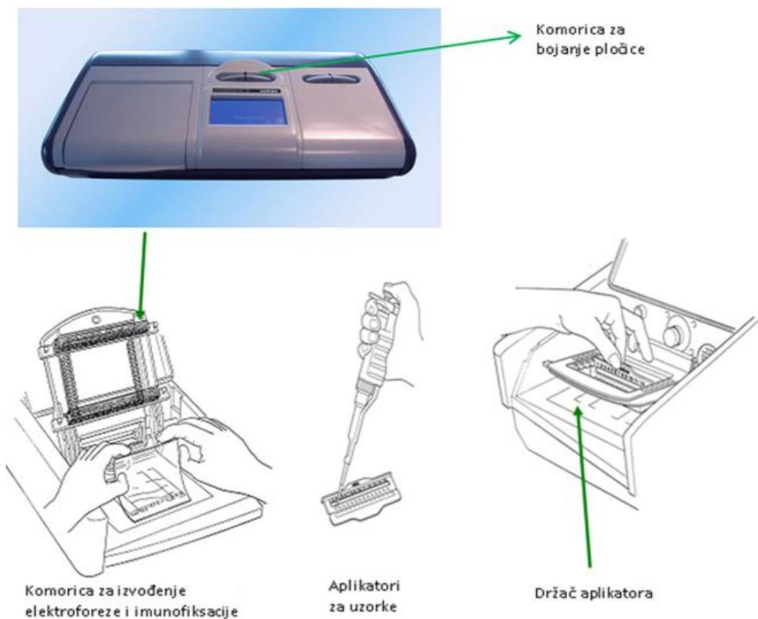
Slika 6. Uređaj za gel-elektroforezu sastoji se od tri modula: komorice za provođenje elektroforeze i imunofiksacije, komorice za bojenje i modula za denzitometriranje. Slika prikazuje slijed radnji u komorici za izvođenje elektroforeze i imunofiksacije.
