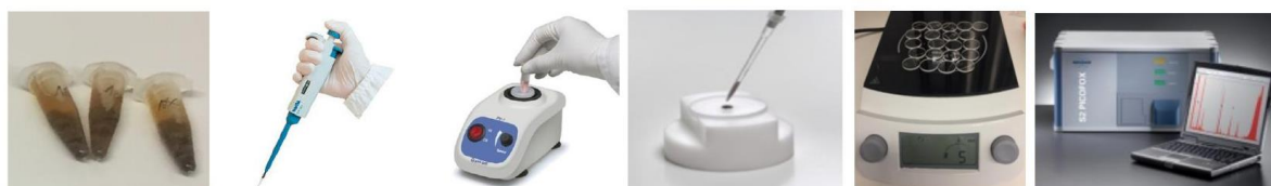
Slika 3. Priprema uzoraka u obliku suspenzije za TXRF analizu.
