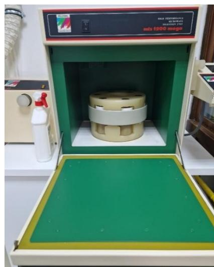
Slika 2. Teflonske kivete s izvaganim uzorcima smještene u uređaj za mikrovalnu digestiju.
