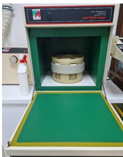
Slika 2. Teflonske kivete s izvaganim uzorcima smještene u uređaj za mikrovalnu digestiju.
