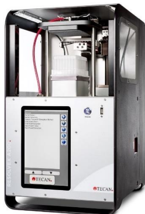
Slika 8. – Tecan Resolvex® A200-automatizirana jedinica za pozitivni tlak (Preuzeto iz https://protifi.com/pages/tecan-a200 )
