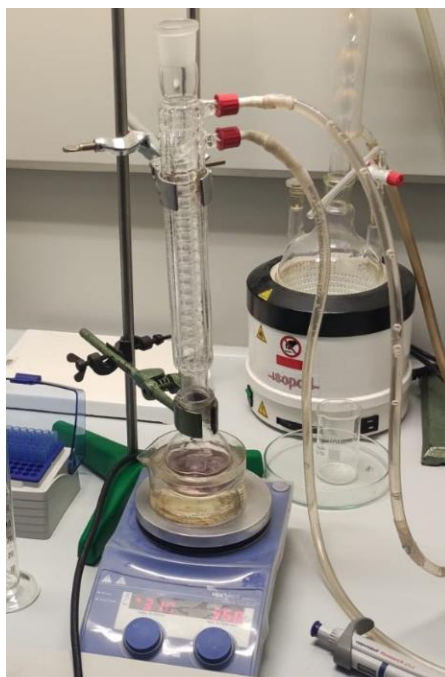
Slika 2. Aparatura za sintezu nanočestica
