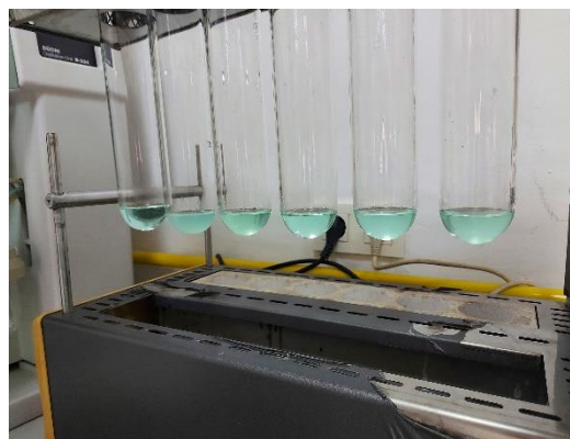
Slika 5. Kivete na kraju spaljivanja
