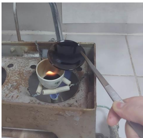
Slika 2. Postupak spaljivanja na plameniku u užarenom lončiću
