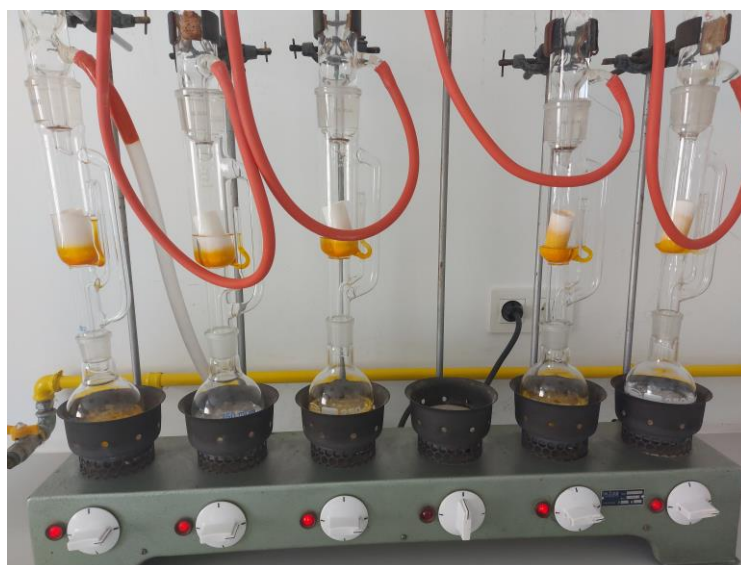
Slika 3. Ekstrakcija lipida po Soxhletu
