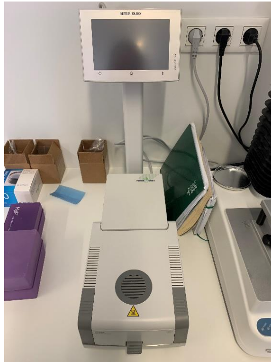
Slika 7. Halogeni vlagomjer (Mettler Toledo, model HX204)
