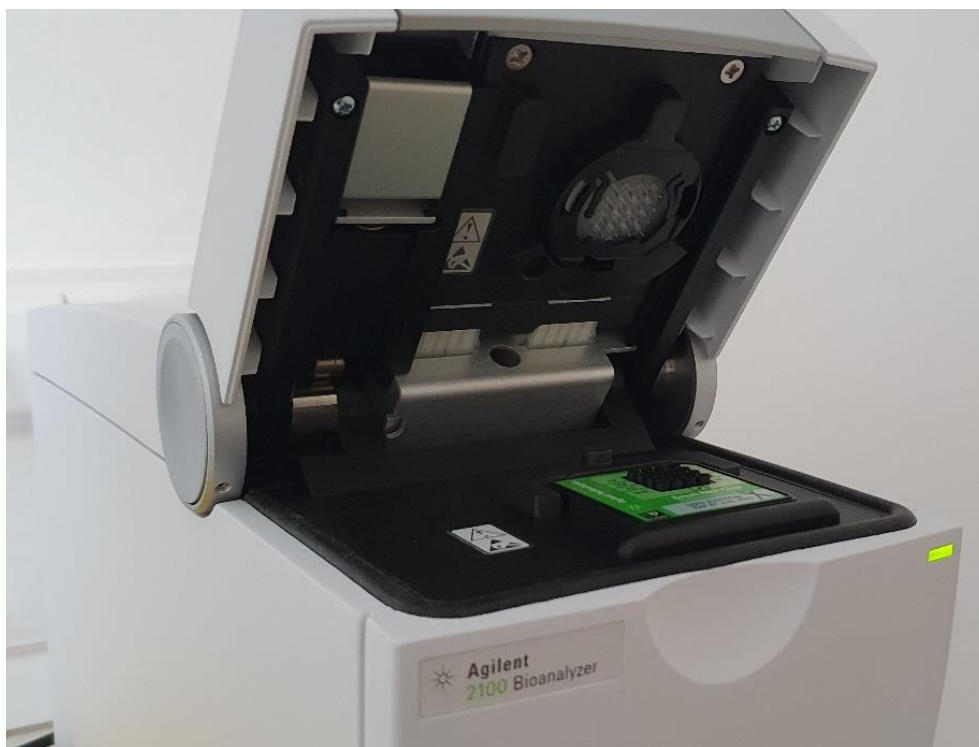
Slika 4. Agilent 2100 Bioanalyzer – Prikaz postavljanja mikrotekućinskog čipa na uređaj.
