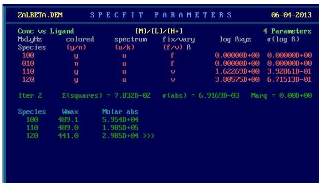
Slika 20. Model s 3 specije – \log \beta_{110} = 1,6 (0,4) , \log \beta_{120} = 3,8 (0,7) , \sigma(\text{abs}) = 0,007 .
