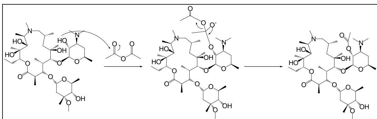
Slika 30. Mehanizam acetiliranja hidroksilne skupine na položaju 2' desozamina.
