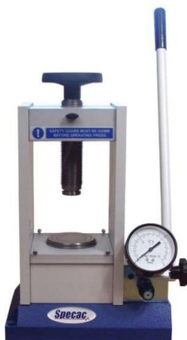
Slika 11. Ručna hidraulična preša (Specac)
