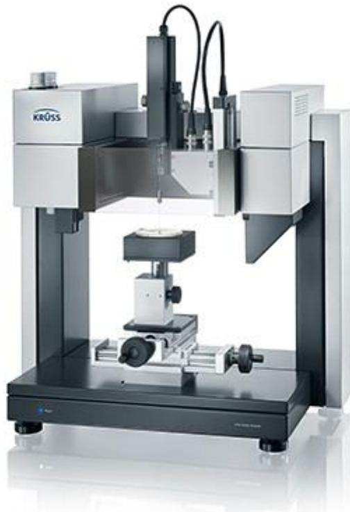
Slika 12. Instrument za mjerenje kuta močenja DSA100 (Krüss)
