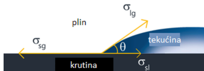
Slika 6. Shematski prikaz komponenata trofaznog sustava koje su značajne za močenje
