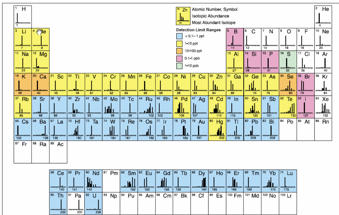
Slika 3. Približan limit detekcije s ICP-MS (preuzeto od PerkinElmer, Inc.)
