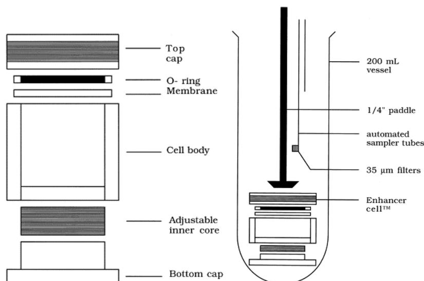
Slika 13, Osnovni dijelovi Enhancer ćelije (Rege, 1998)
