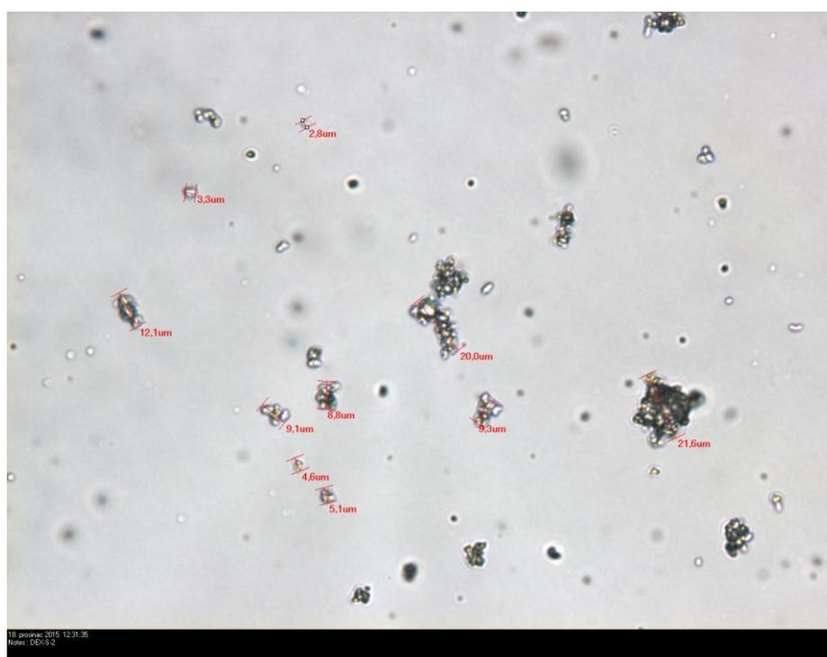
Slika 22, Čestice suspenzije S2 (poloksamer 188) nepodvrgnute homogenizaciji pri povećanju 50x
