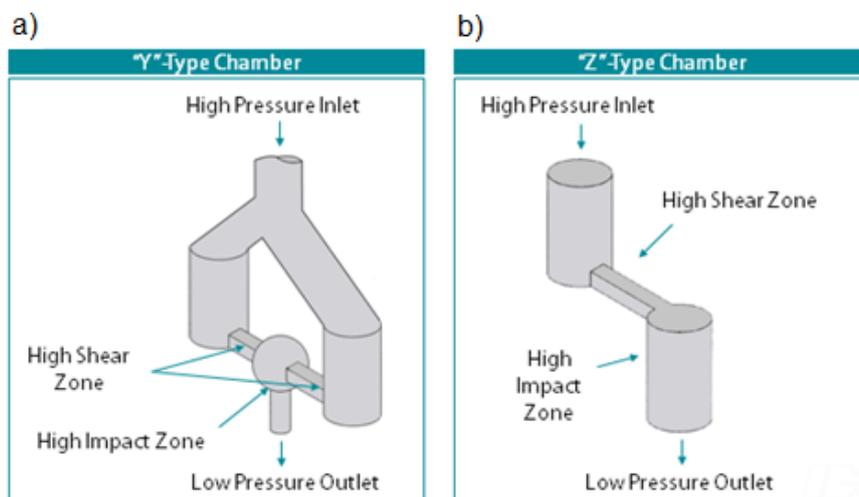
Slika 4, Dvije izvedbe mikokanalića mikrofluidizatora (Microfluidics, 2013)
