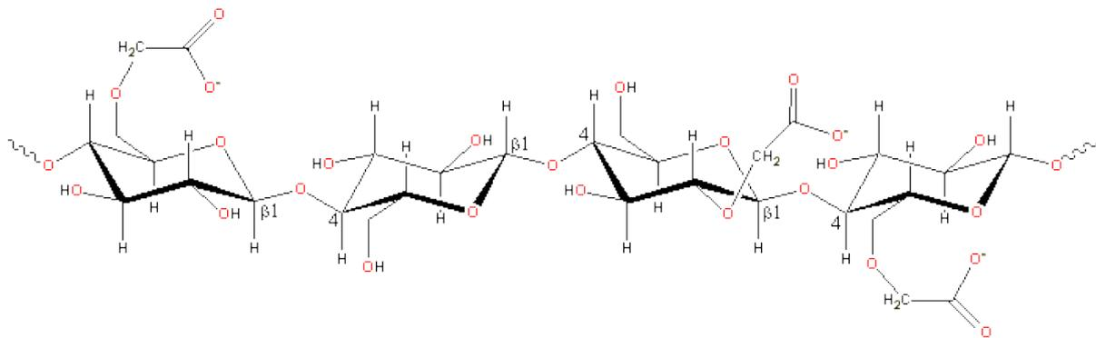
*Slika 10, Struktura karboksimetilceluloze (Water Structure and Science, 2015)*
