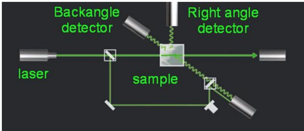
Slika 11, Optički dijelovi DLS anaizatora veličina čestica (Horiba-Scientific, 2016)
