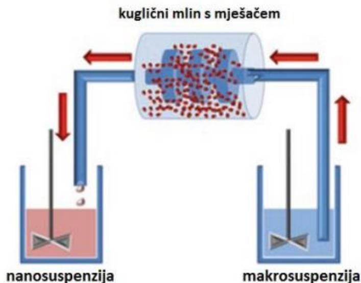
Slika 2, Priprava nanosuspenzija mljevenjem u kugličnom mlinu (Pepić, 2015)
