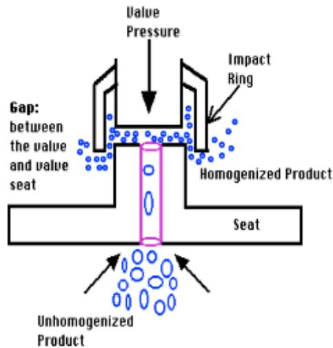
Slika 3, Princip rada piston-gap uređaja za homogenizaciju (Dhankhar, 2014)
