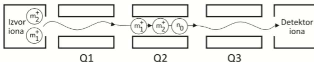
Slika 2: Shematski prikaz trostrukog kvadrupola
