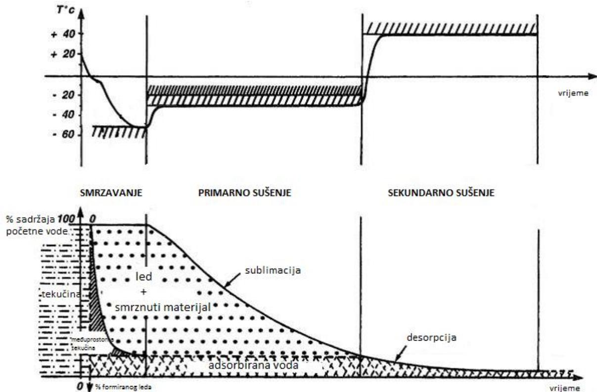
**Slika 3.** Promjena temperature i sadržaja vode tijekom pojedinih koraka liofilizacije
