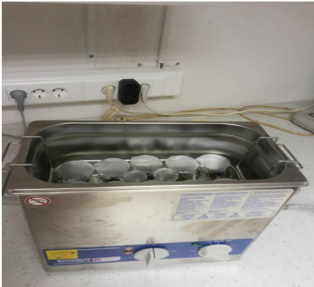
Slika 6. Ultrazvučna ekstrakcija biljnog materijala
