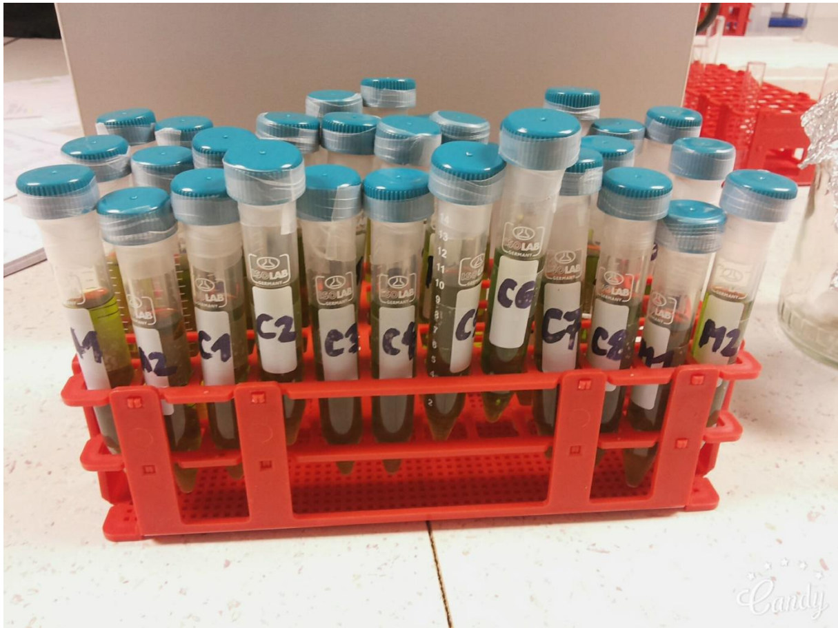
Slika 8. Ekstrakti spremljeni u označene Falconice nakon provedene ultrazvučne ekstrakcije
